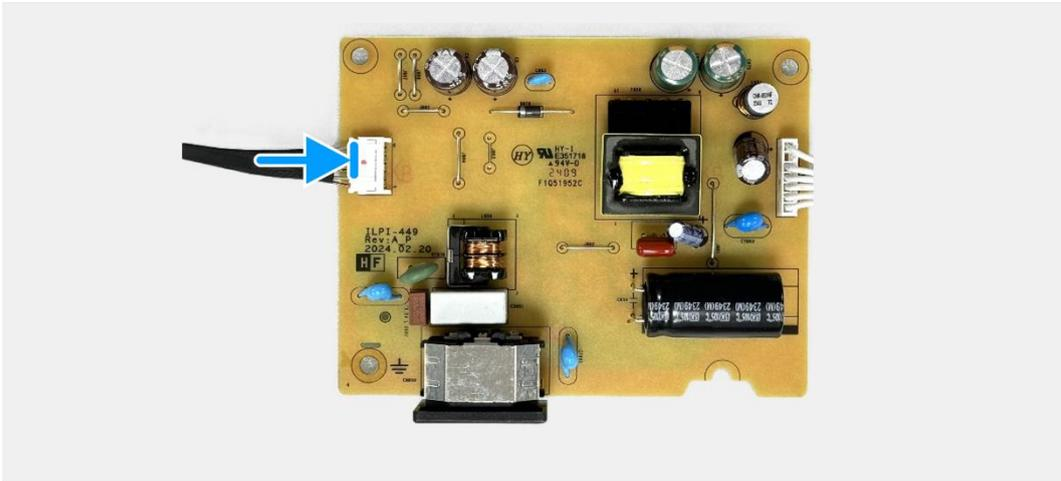
**Imagen 22.** Instalación de la placa de alimentación
