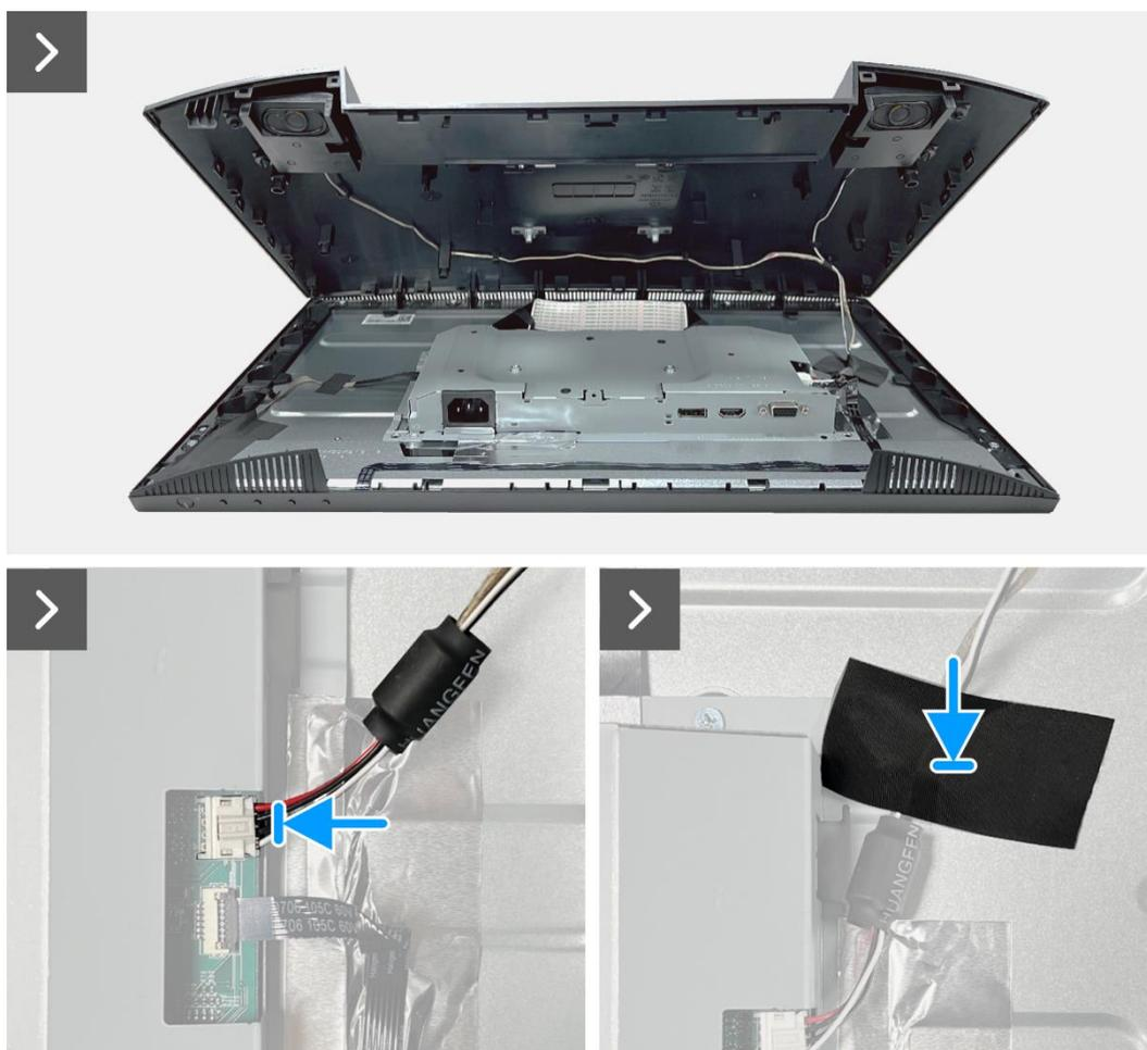
**Imagen 5.** Instalación de la cubierta trasera
