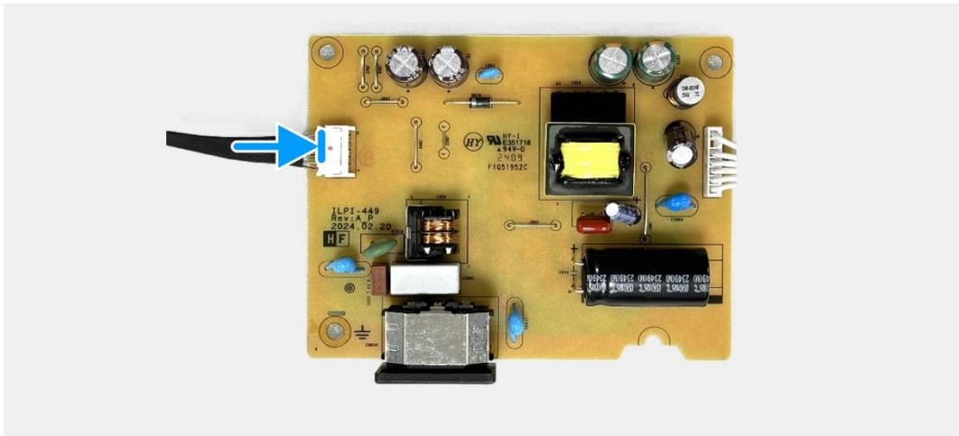
**Imagen 44.** Instalación de la placa de alimentación
