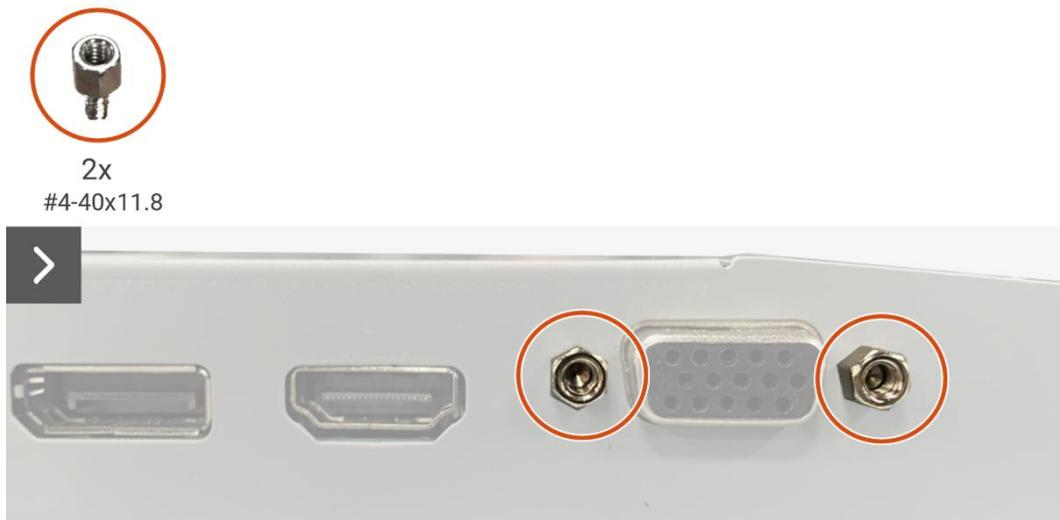
**Imagen 37.** Extracción de la placa de la interfaz
