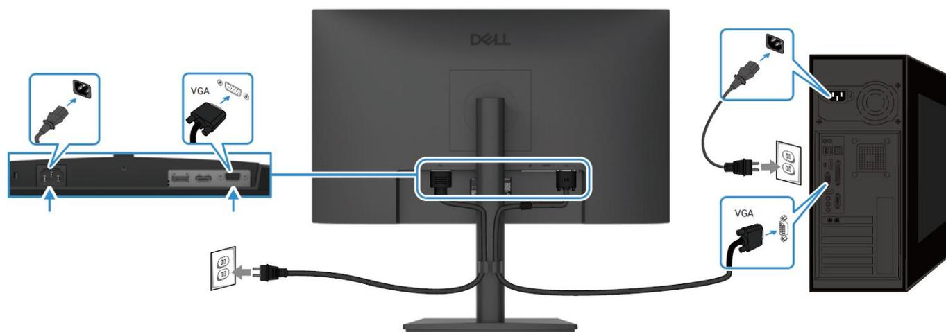
Imagen 7. Conexión del cable VGA
