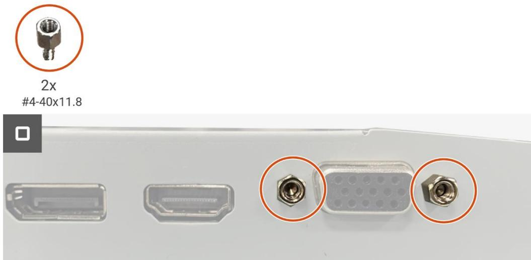
**Imagen 51.** Instalación de la placa de la interfaz
