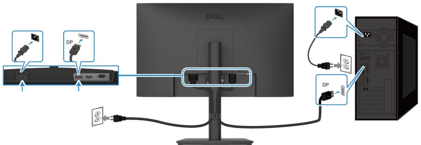
Imagen 8. Conexión del cable DP
