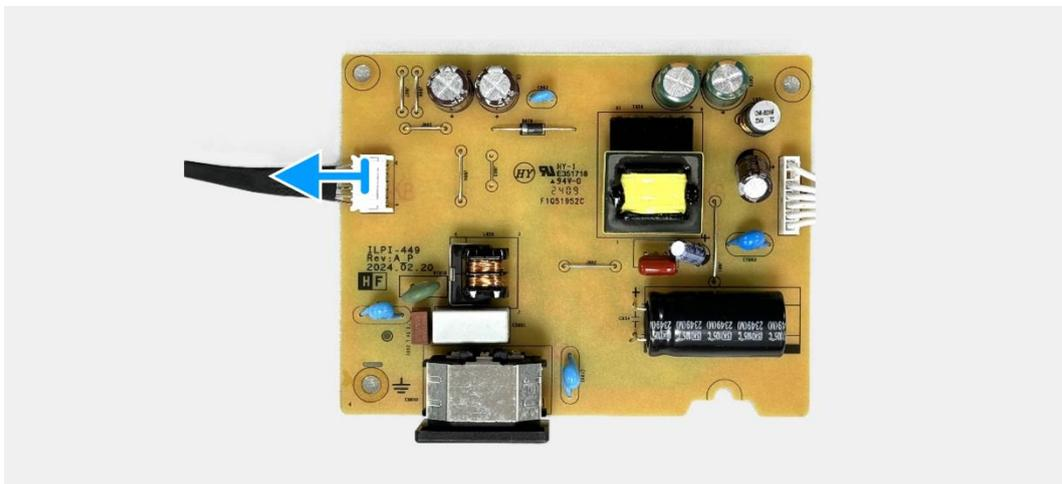
**Imagen 52.** Extracción de la placa de alimentación
