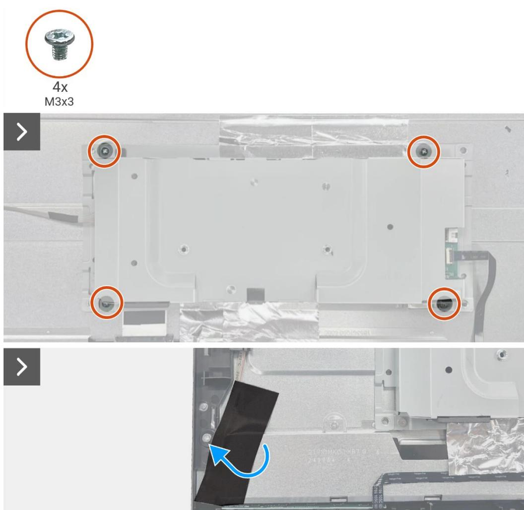
**Imagen 40.** Extracción del ensamblaje del chasis
