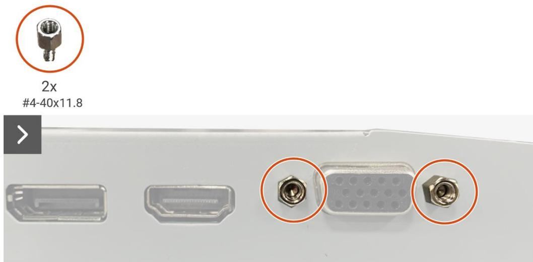
**Imagen 24.** Extracción de la placa de la interfaz
