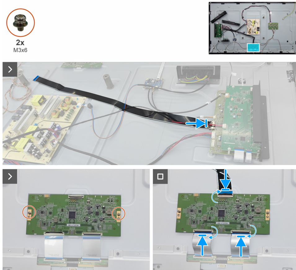
Figure 35. Installation de la carte T-CON
