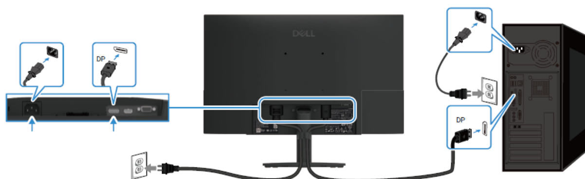
Rysunek 9. Podłączanie kabla DP
