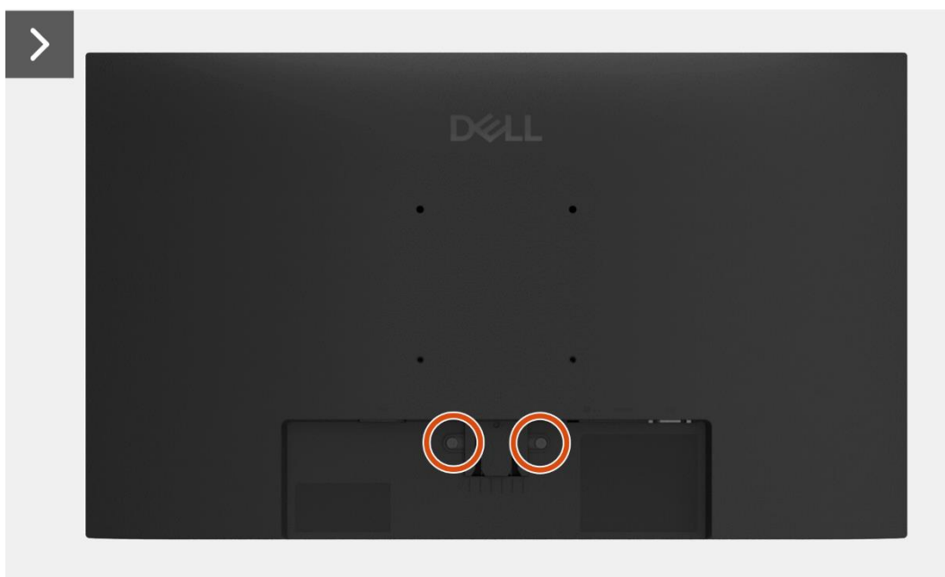
Rysunek 13. Zdejmowanie tylnej pokrywy
