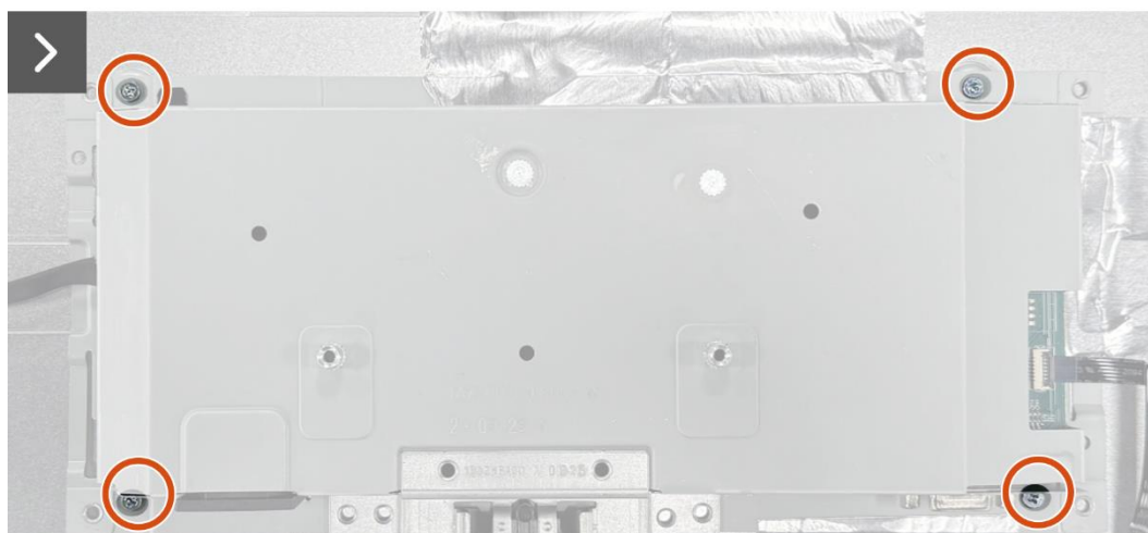
Rysunek 18. Instalowanie zespołu obudowy
