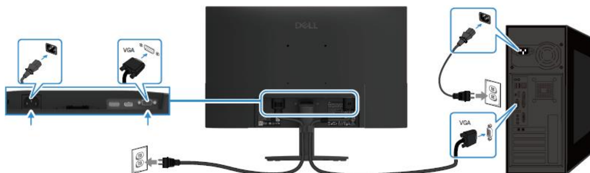
Rysunek 8. Podłączanie kabla VGA
