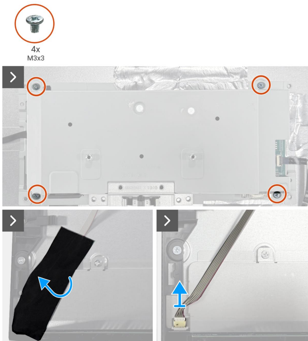
Figura 6. Remover o conjunto da base inferior
