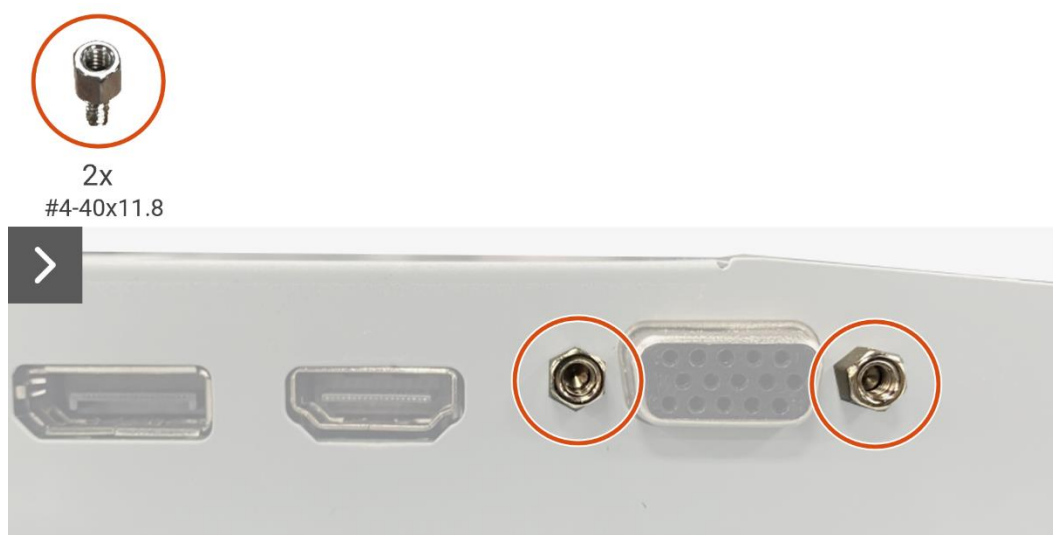
Figura 12. Remover a placa de interface
