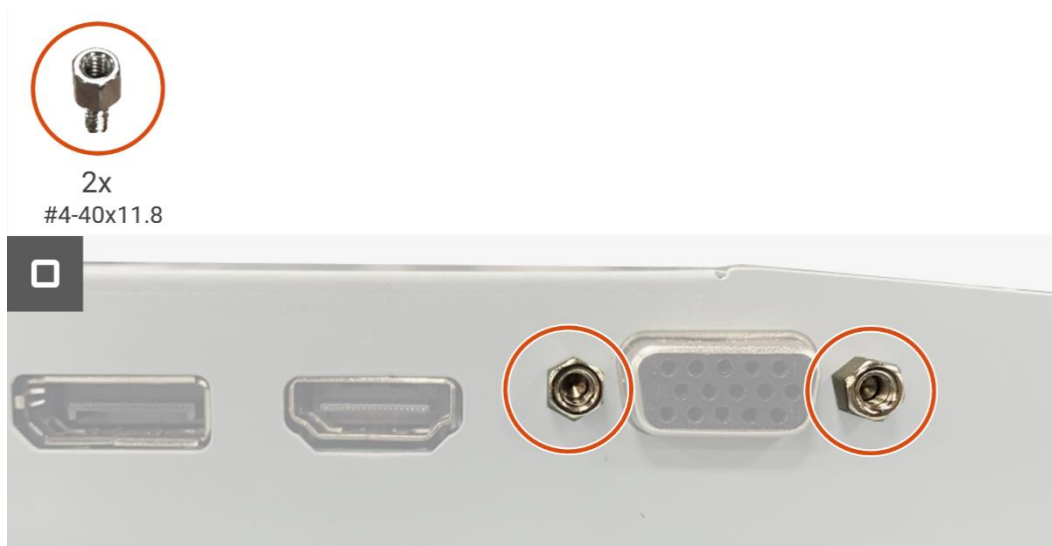
Figura 17. Instalação da placa de interface
