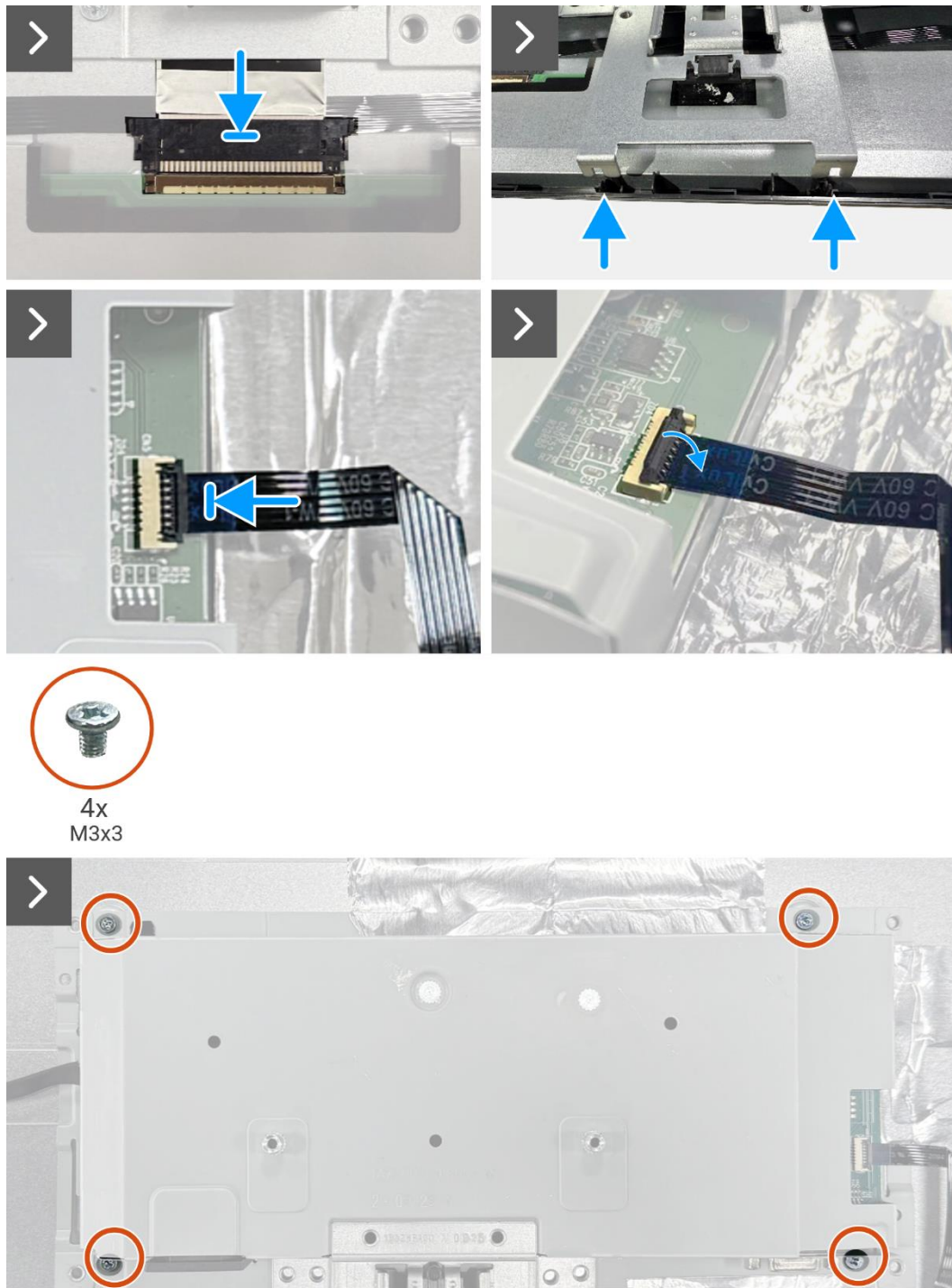
Figura 8. Instalação do conjunto da base inferior
