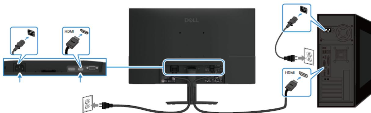
Figura 10. Conectar o cabo HDMI
