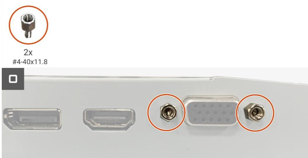
**Figura 27. Instalação da placa de interface**
