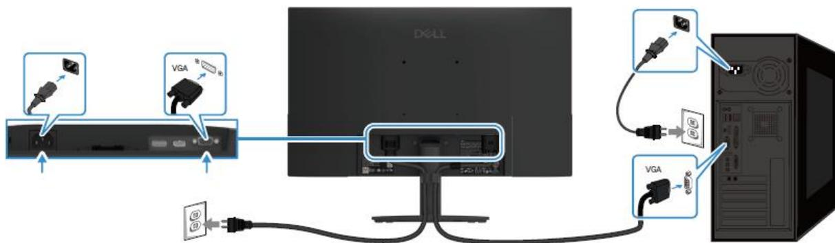
Figura 8. Conectar o cabo VGA
