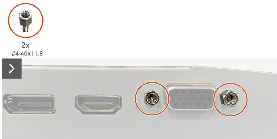
**Figura 22.** Remover a placa de interface
