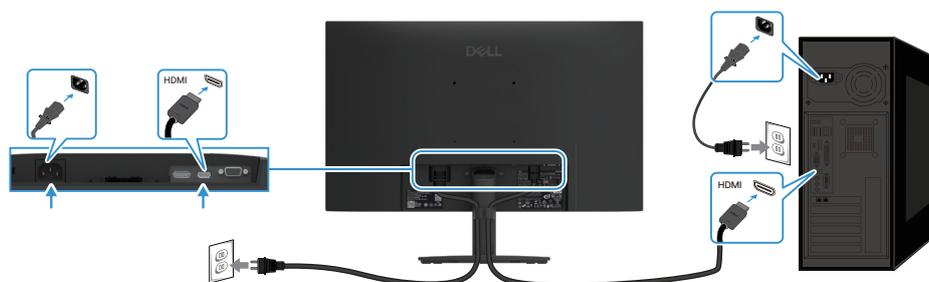
Figura 16. Collegamento del cavo HDMI
