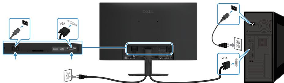
Figura 14. Collegamento del cavo VGA
