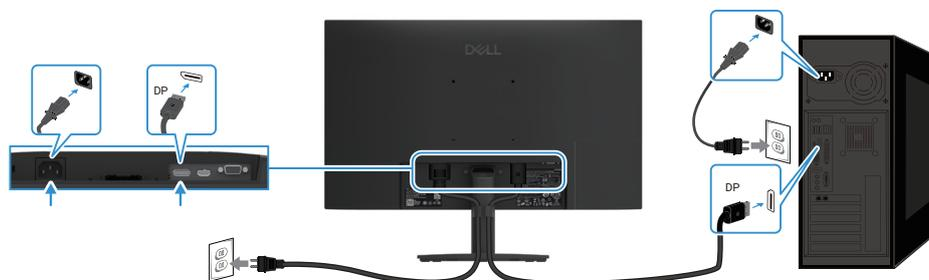
Figura 15. Collegamento del cavo DP
