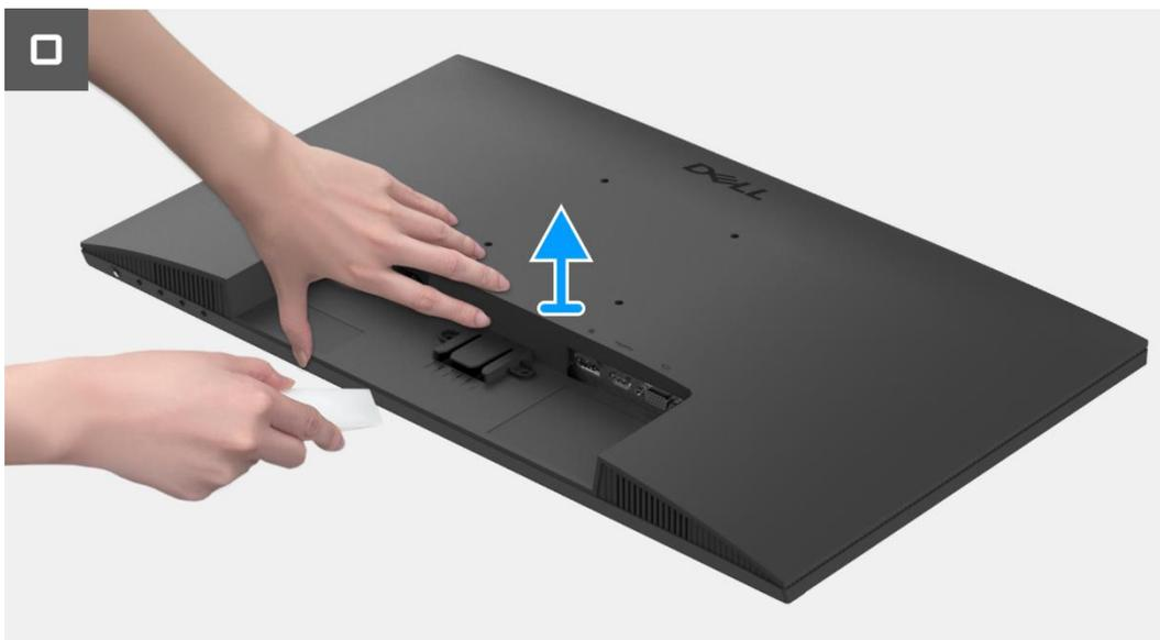
**Figura 4.** Rimozione della copertura posteriore
