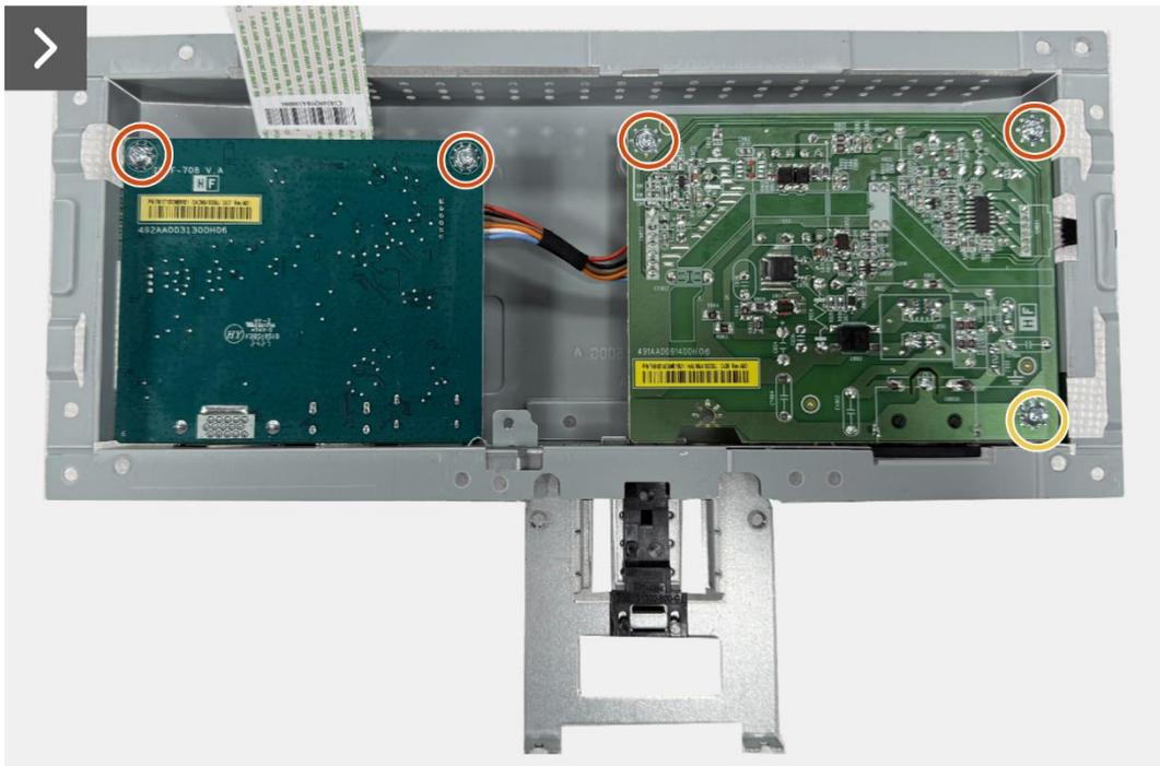
**Figura 13.** Rimozione della scheda di interfaccia
