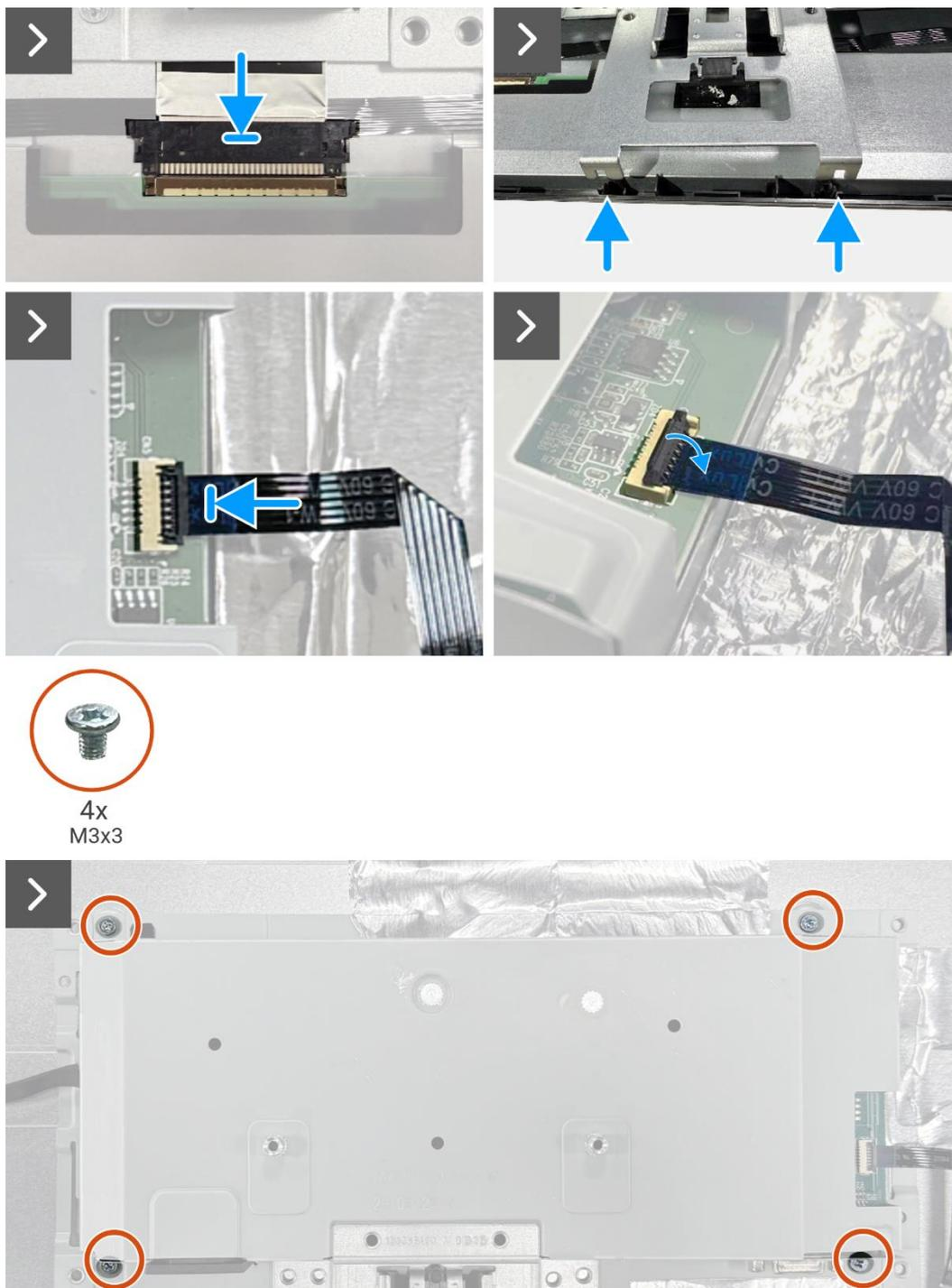
Figure 8. Installation de l'assemblage du cadre
