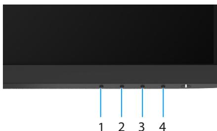
Schéma 43. Boutons de fonction de diagnostic intégrés
