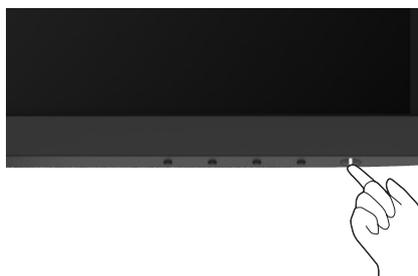
Schéma 24. Mettre le moniteur sous tension
