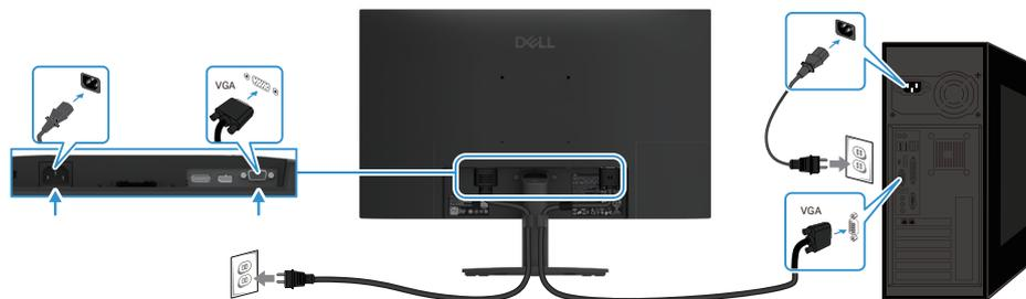
Schéma 14. Connexion du câble VGA
