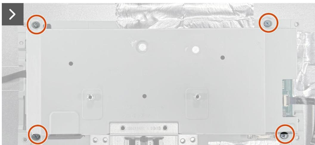
**Figura 18.** Installazione del gruppo telaio
