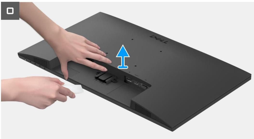
**Figura 14.** Rimozione della copertura posteriore
