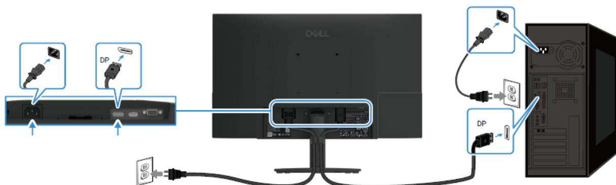
Figura 9. Collegamento del cavo DP
