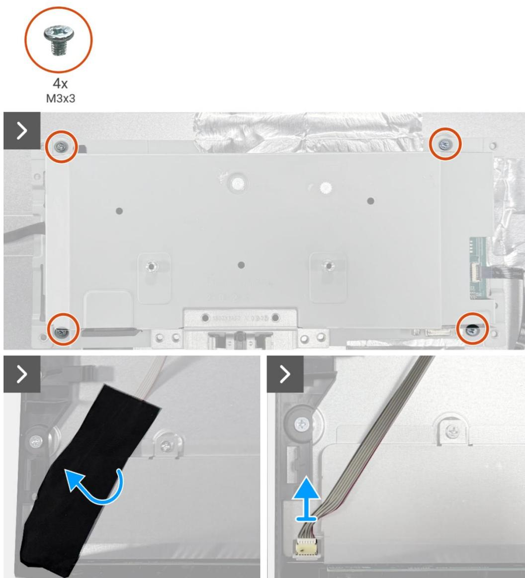
**Figura 16.** Rimozione del gruppo telaio
