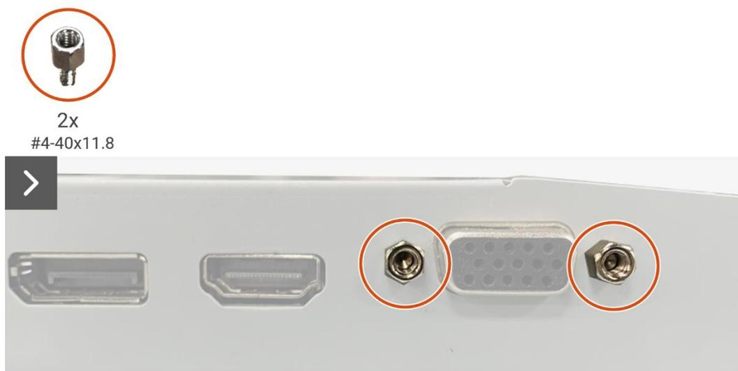
**Figura 22.** Rimozione della scheda di interfaccia
