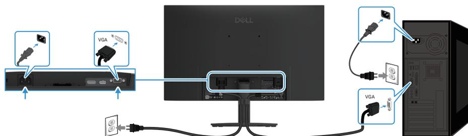
Figura 14. Conectar el cable VGA
