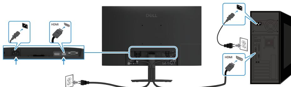
Figura 16. Conectar el cable HDMI
