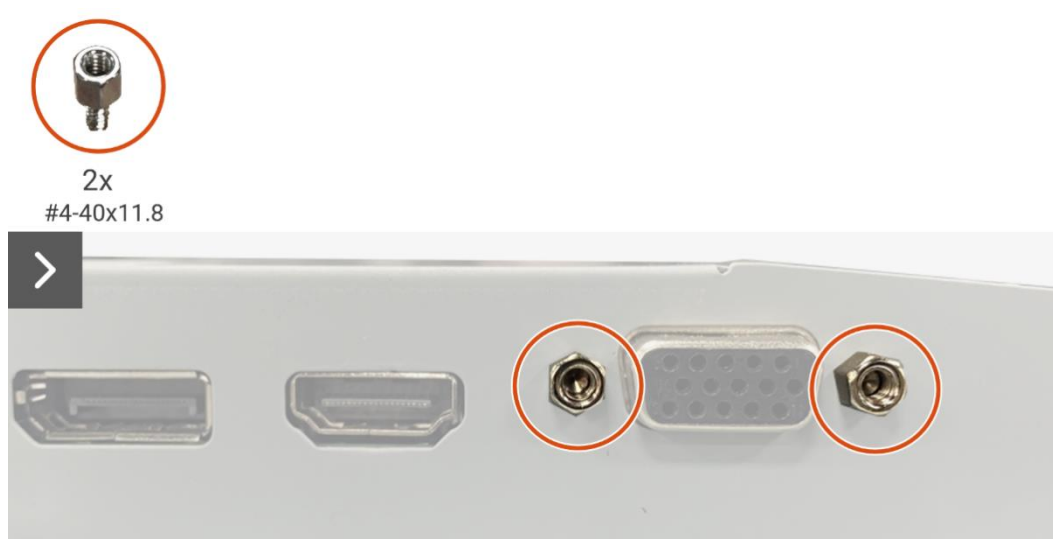
Obrázek 22. Odmontování desky rozhraní
