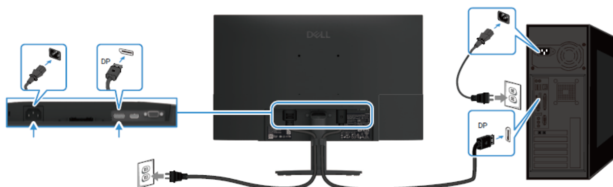
Obrázek 9. Připojení kabelu DP
