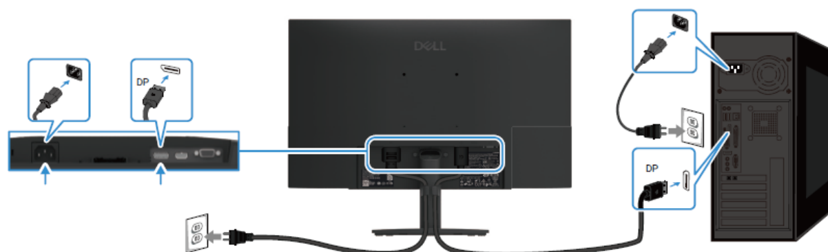
Figure 9. Connexion du câble DP
