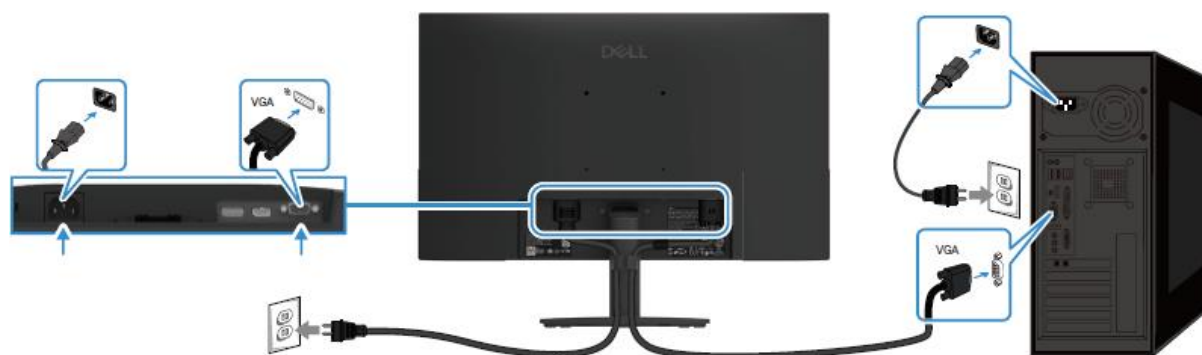
Figure 8. Connexion du câble VGA
