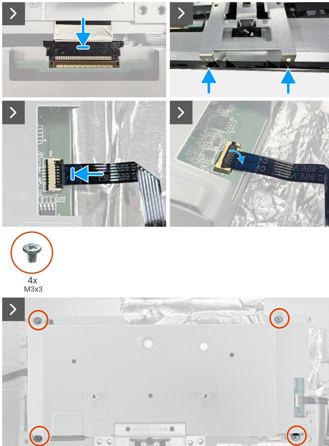
Figure 18. Installation de l'assemblage du cadre
