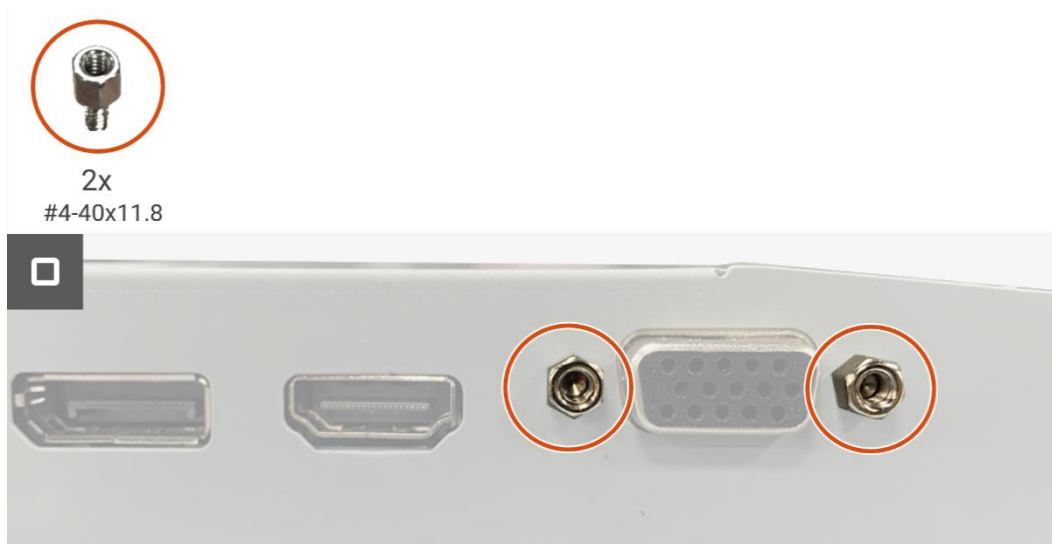
Imagen 17. Instalación de la placa de la interfaz
