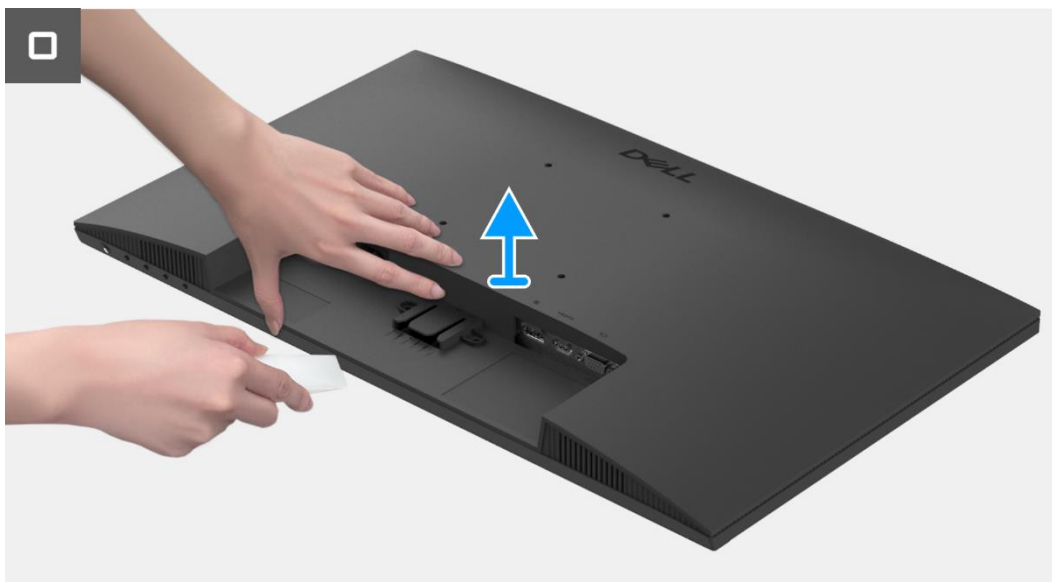
Imagen 4. Extracción de la cubierta trasera
