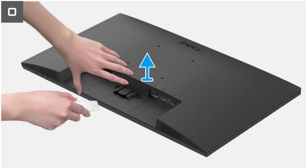
**Imagen 14.** Extracción de la cubierta trasera
