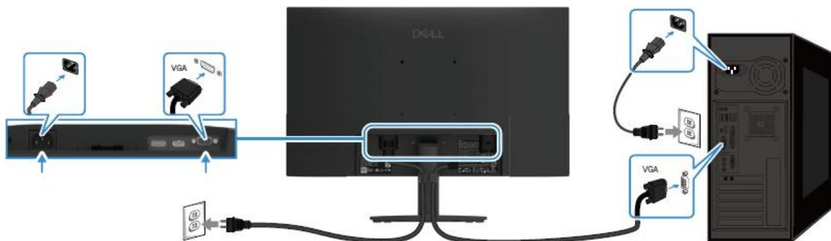
Imagen 8. Conexión del cable VGA
