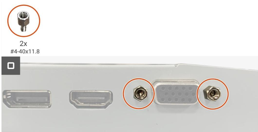
**Imagen 27.** Instalación de la placa de la interfaz
