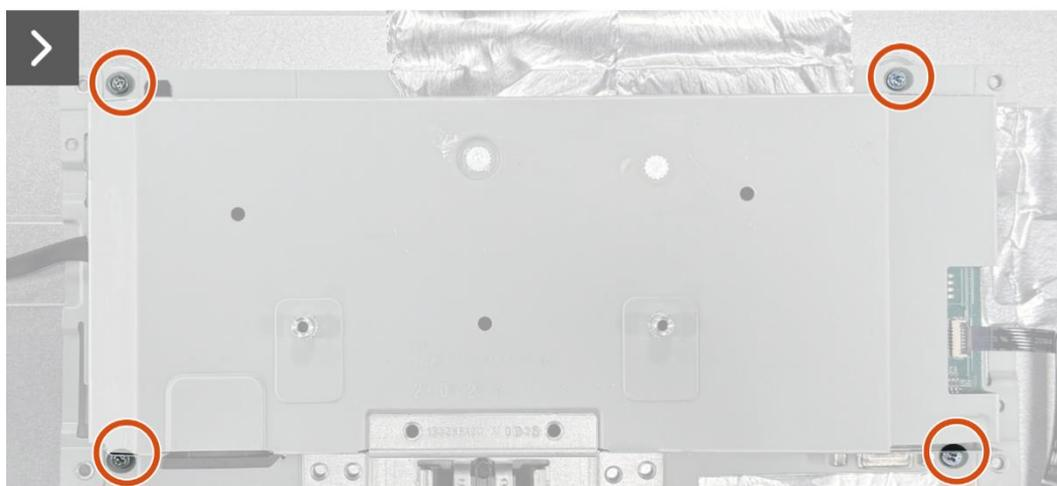
**Imagen 18.** Instalación del ensamblaje del chasis
