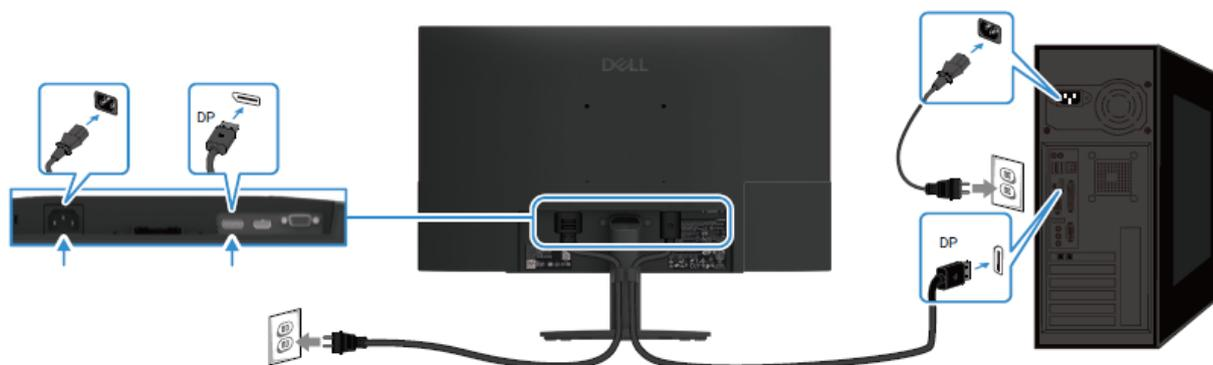
Imagen 9. Conexión del cable DP
