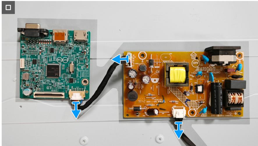
**Figura 13.** Remover a placa do sistema e a placa de alimentação
