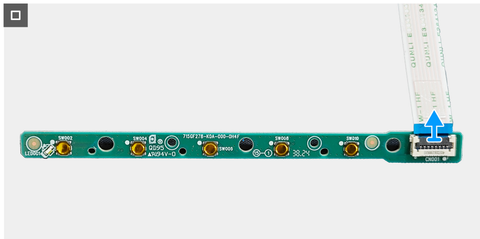
Figura 19. Remover a placa de botões
