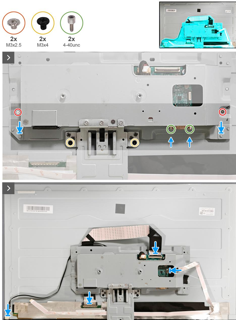
**Figura 17.** Installazione della schermatura metallica
