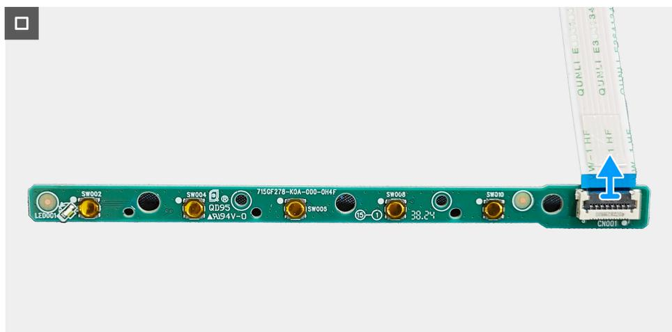
**Figura 19.** Rimozione della scheda del tastierino
