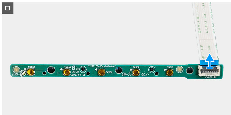
Obrázek 19. Demontáž tlačítkové desky
