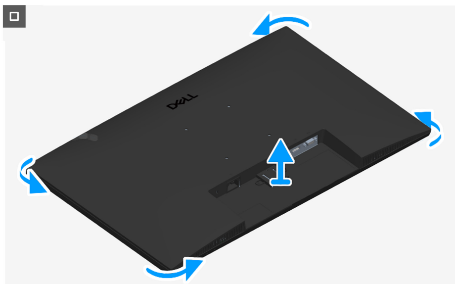
Obrázek 12. Demontáž zadního krytu
