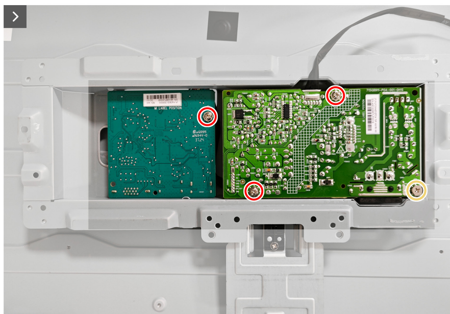
Figura 21. Quitar la placa del sistema y la placa de alimentación
