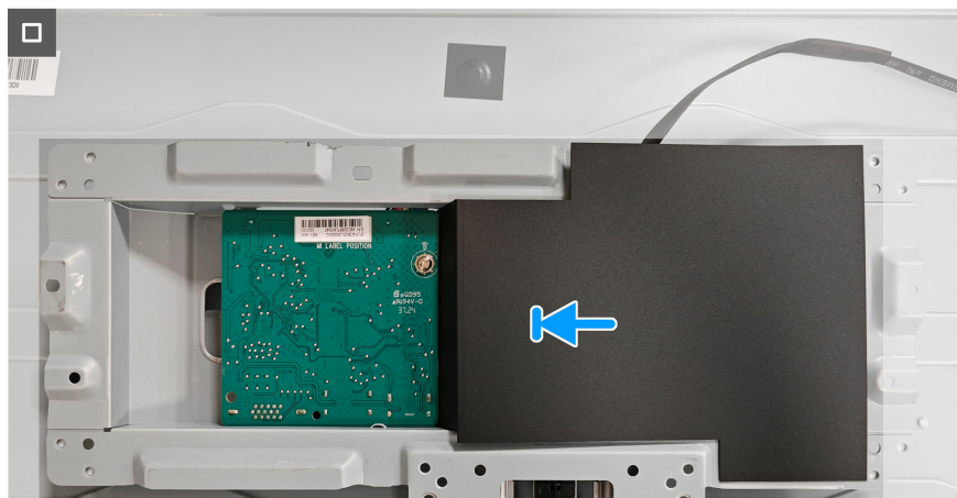
Figura 14. Instalar la placa del sistema y la placa de alimentación
