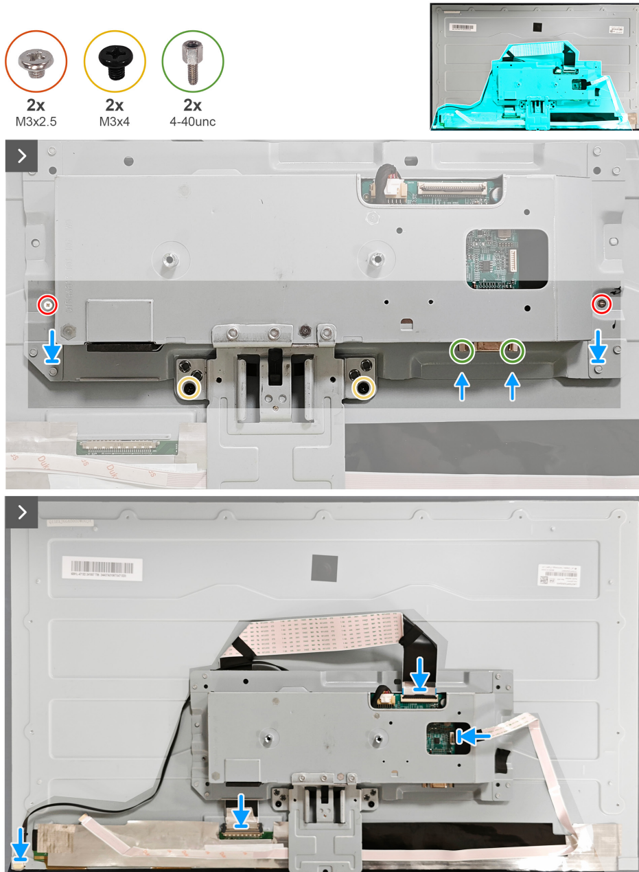
Figura 8. Instalar la protección metálica
