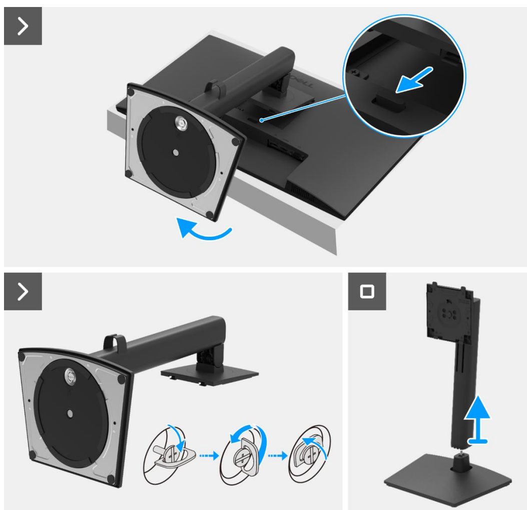
Rysunek 23. Demontaż podstawy
