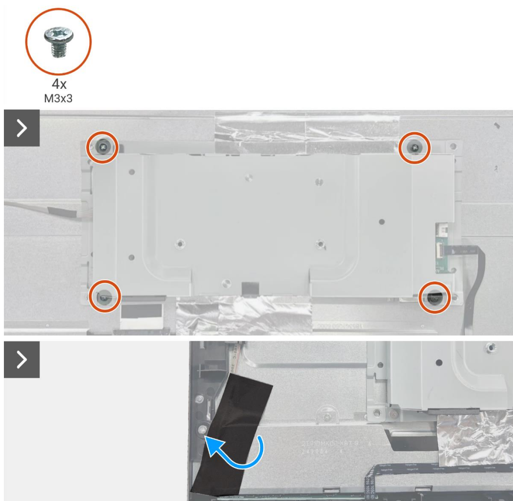
Rysunek 31. Demontaż zespołu obudowy
