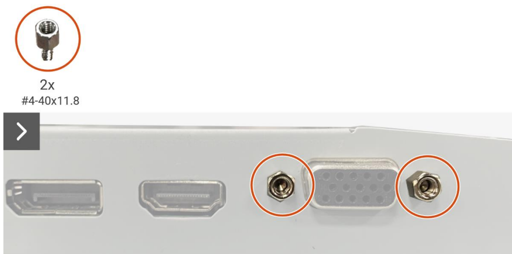
Rysunek 37. Wyjmowanie karty interfejsu
