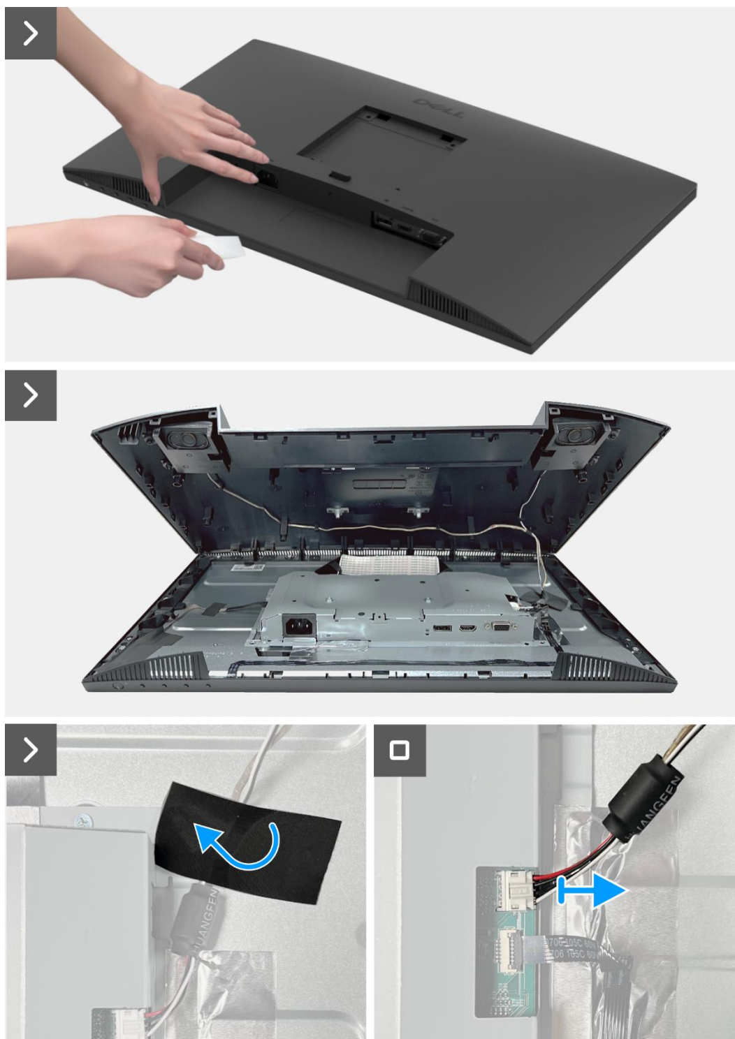
Figura 13. Rimozione della copertura posteriore
