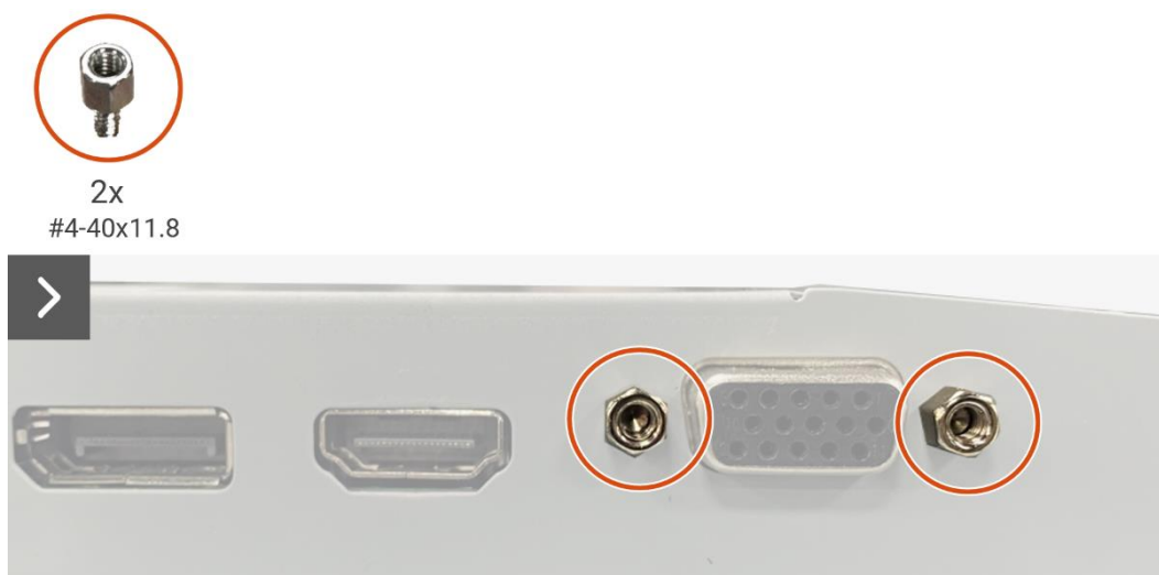
Figura 24. Rimozione della scheda di interfaccia
