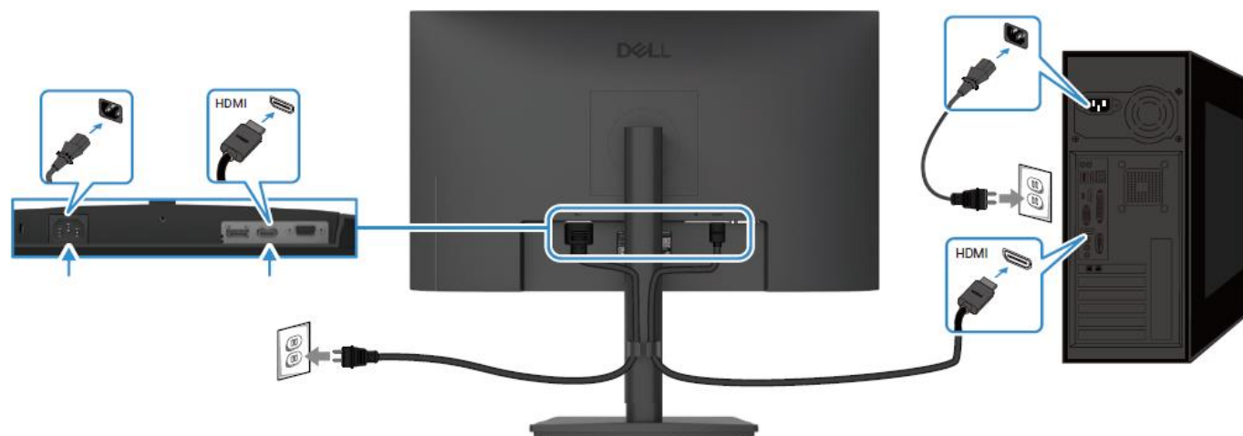
Figura 9. Collegamento del cavo HDMI
