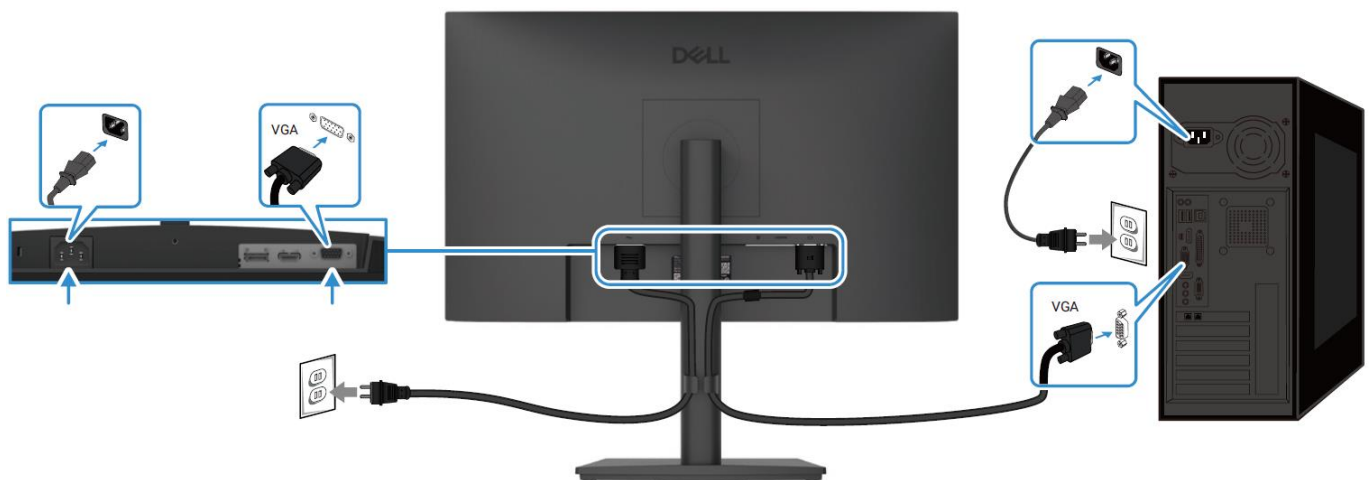
Figura 7. Collegamento del cavo VGA
