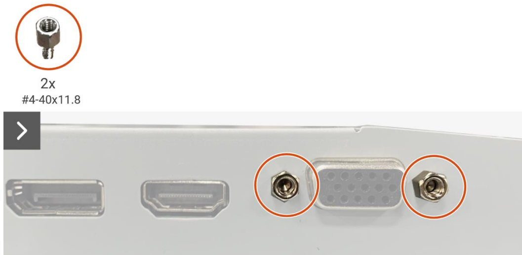
Figura 46. Rimozione della scheda di interfaccia
