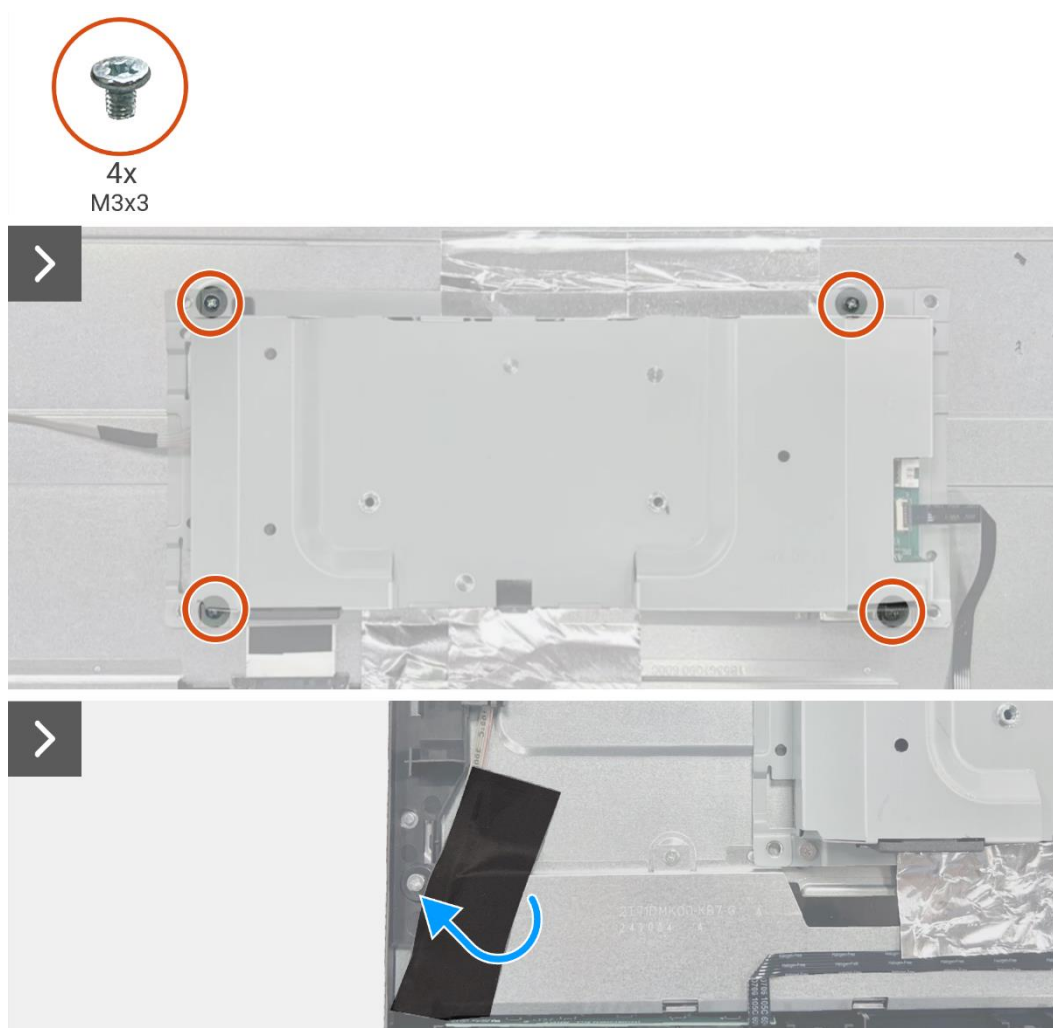
Figura 40. Rimozione del gruppo telaio
