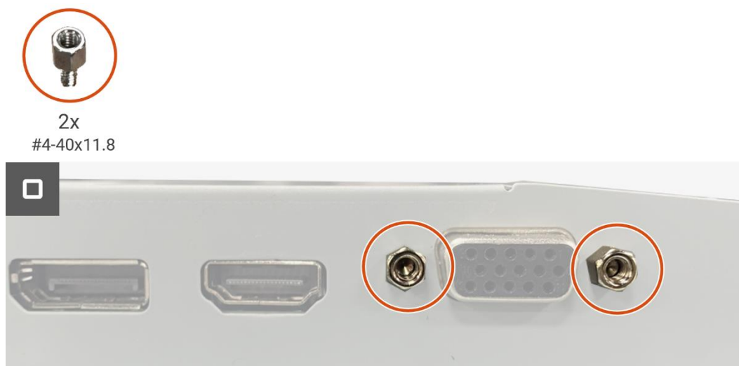
Figura 29. Installazione della scheda di interfaccia
