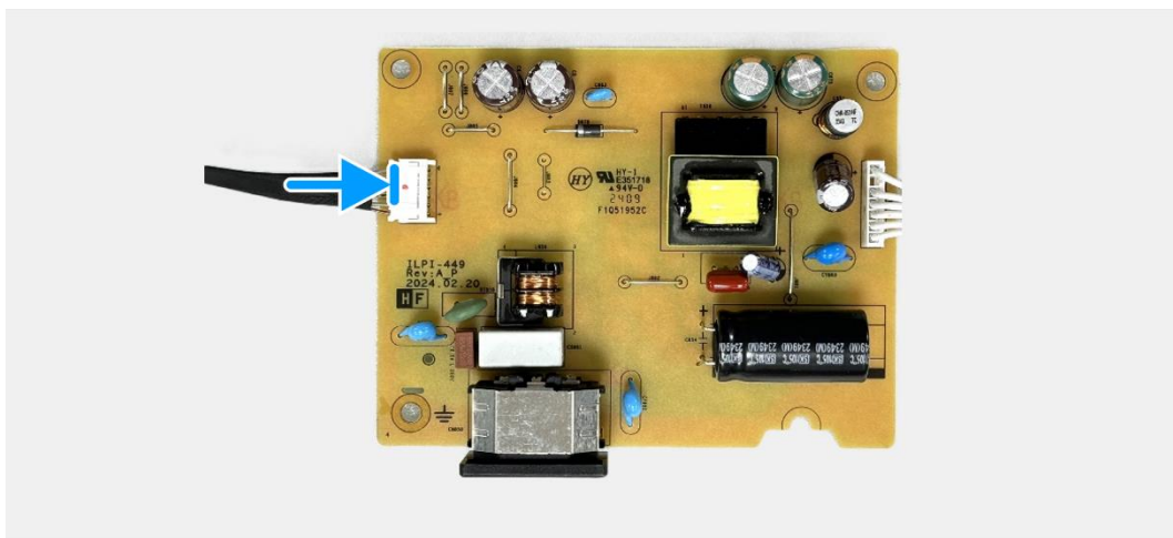
Obrázek 53. Instalace napájecí desky
