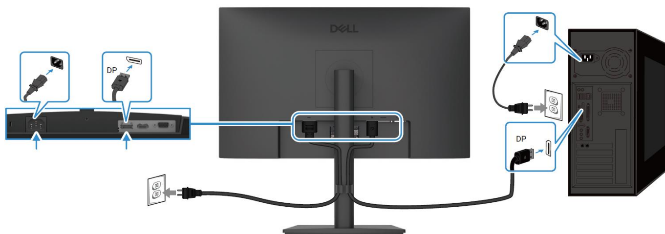
Obrázek 8. Připojení kabelu DP
