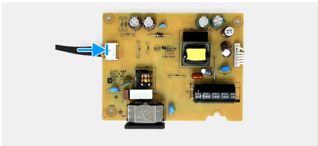
Obrázek 44. Instalace napájecí desky
