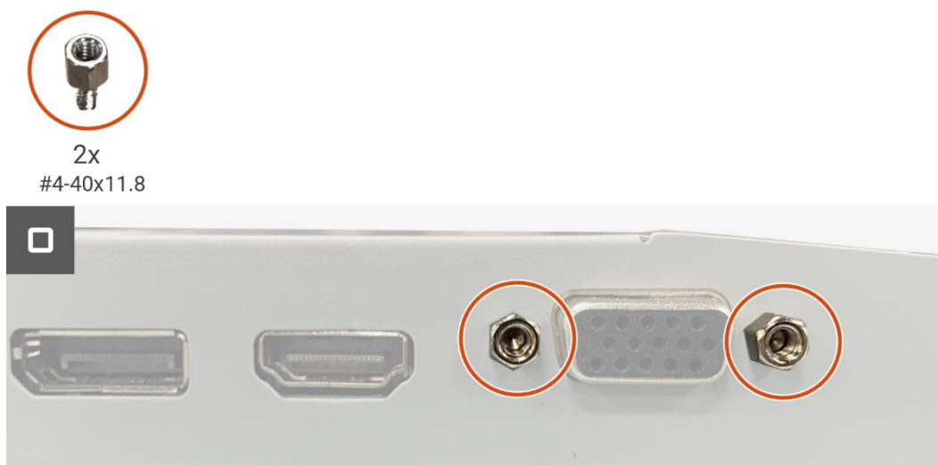
Obrázek 42. Instalace desky rozhraní
