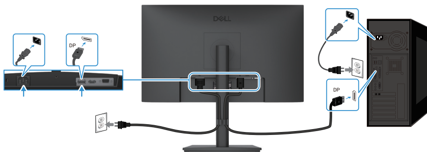
Obrázek 15. Připojení kabelu DP
