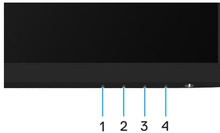
Abbildung 44. Integrierte Diagnosefunktionstasten
