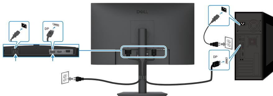
Abbildung 15. Anschließen des DP-Kabels
