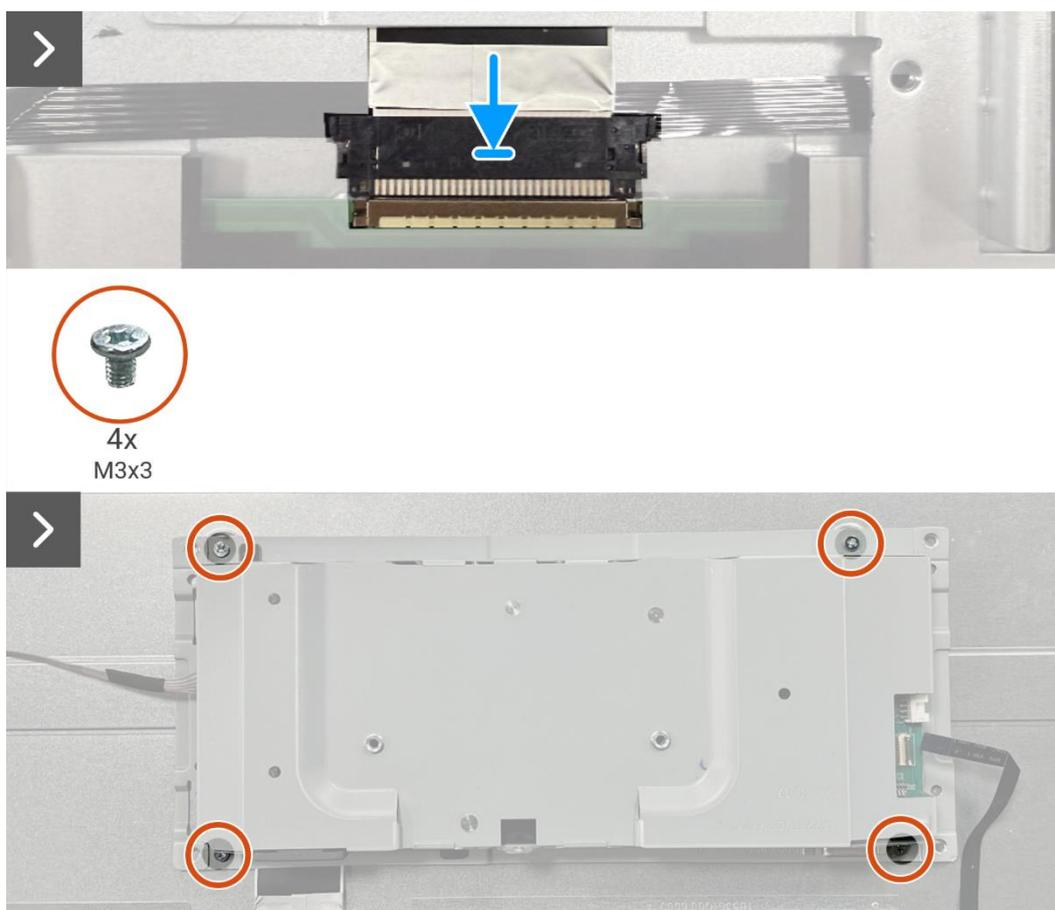
**Figure 33.** Installation de l'assemblage du cadre
