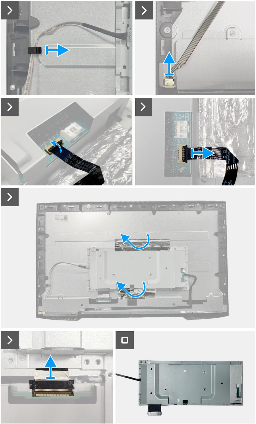
Figure 32. Retrait de l'assemblage du cadre
