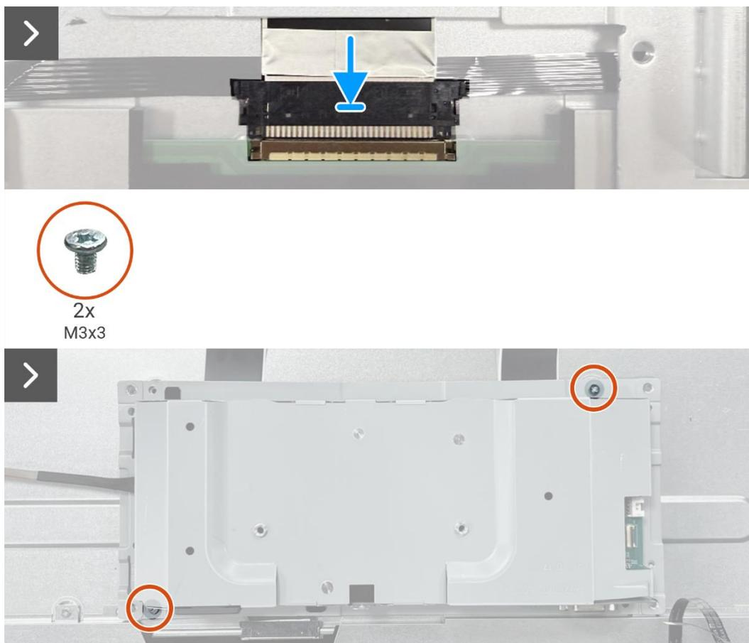
Figure 11. Installation de l'assemblage du cadre
