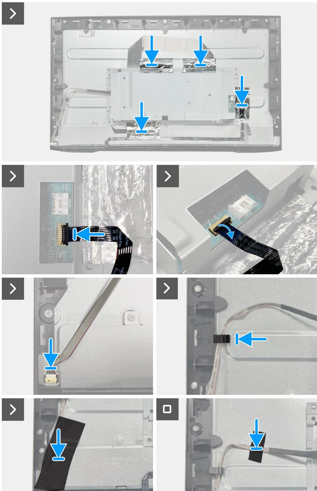
**Figure 12. Installation de l'assemblage du cadre**
