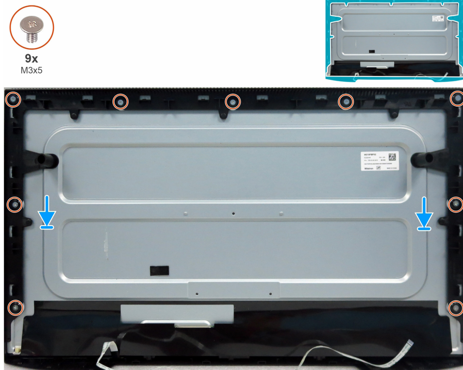
Rysunek 10. Instalowanie ramy wewnętrznej
