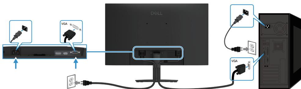
Figura 7. Conexão do cabo VGA
