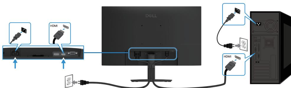
Figura 9. Conexão do cabo HDMI
