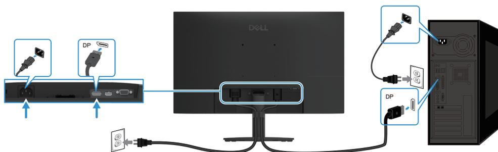
Figura 8. Conexão do cabo DP
