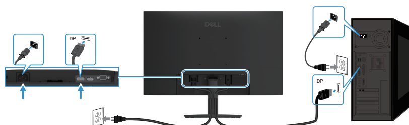
Figura 15. Conexão do cabo DP
