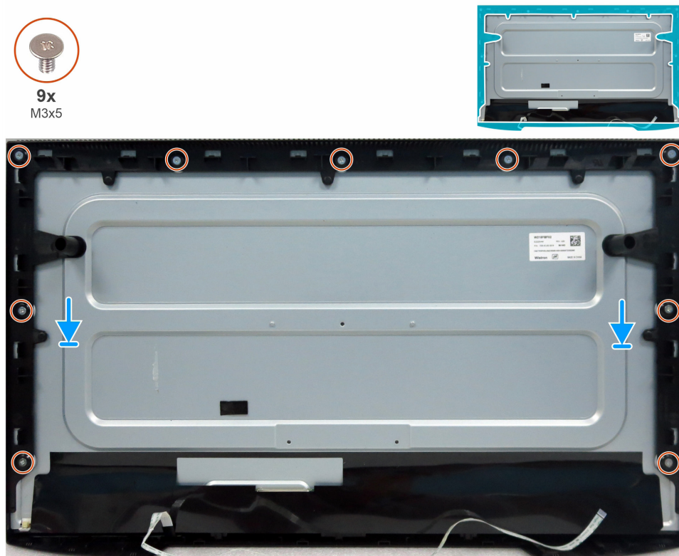
Figura 10. Installazione del telaio centrale
