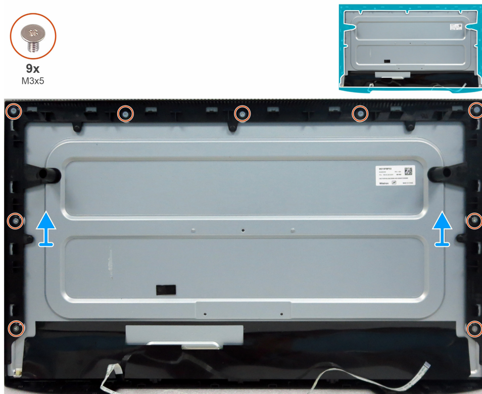
Figura 9. Rimozione del telaio centrale
