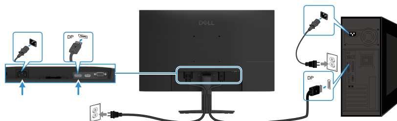
Schéma 15. Branchement du câble DP
