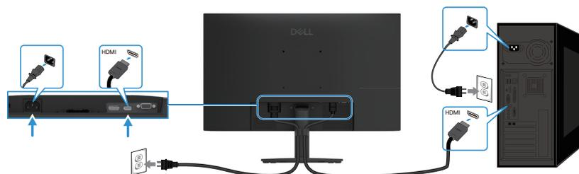
Figura 16. Collegamento del cavo HDMI
