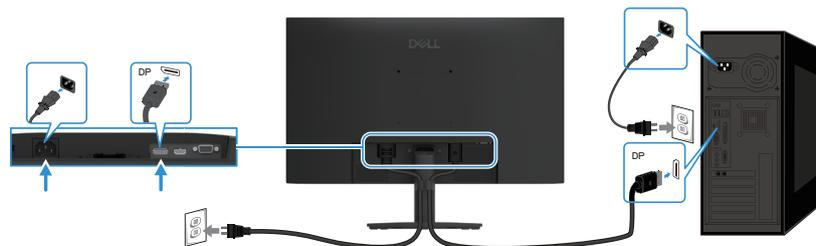
Figura 15. Collegamento del cavo DP
