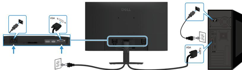
Figura 14. Collegamento del cavo VGA
