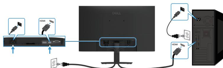
Figura 16. Conectar el cable HDMI
