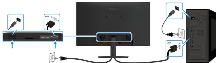
Figura 14. Conectar el cable VGA
