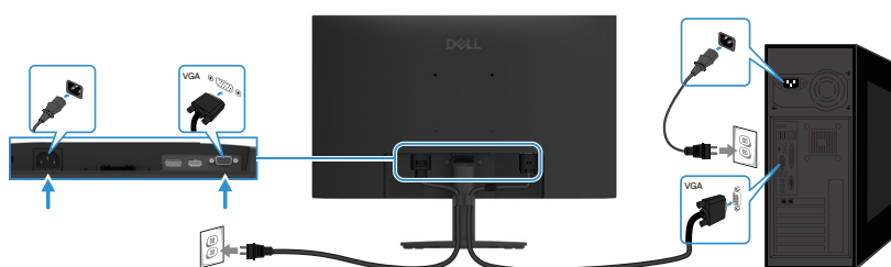
Obrázek 14. Připojení kabelu VGA
