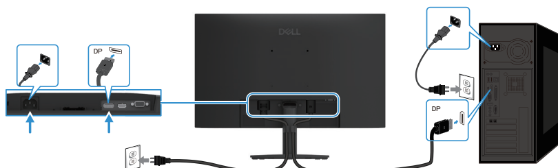
Obrázek 15. Připojení kabelu DP
