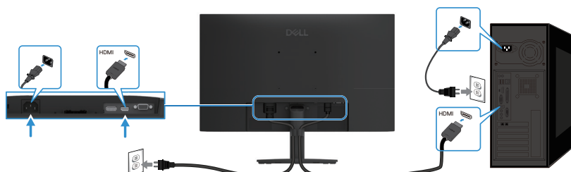
Obrázek 16. Připojení kabelu HDMI
