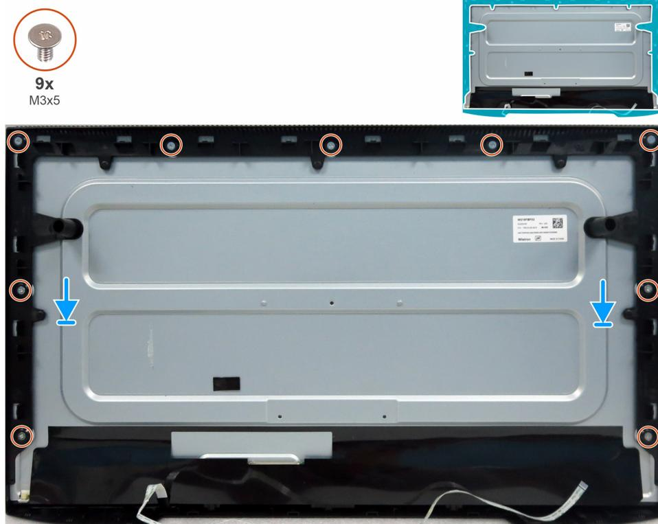
**Figure 10.** Installation du cadre intermédiaire
