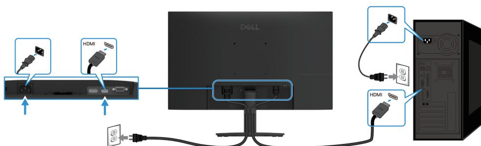
Figure 9. Branchement du câble HDMI
