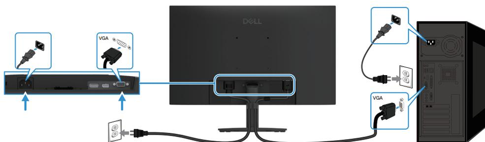
Figure 7. Branchement du câble VGA
