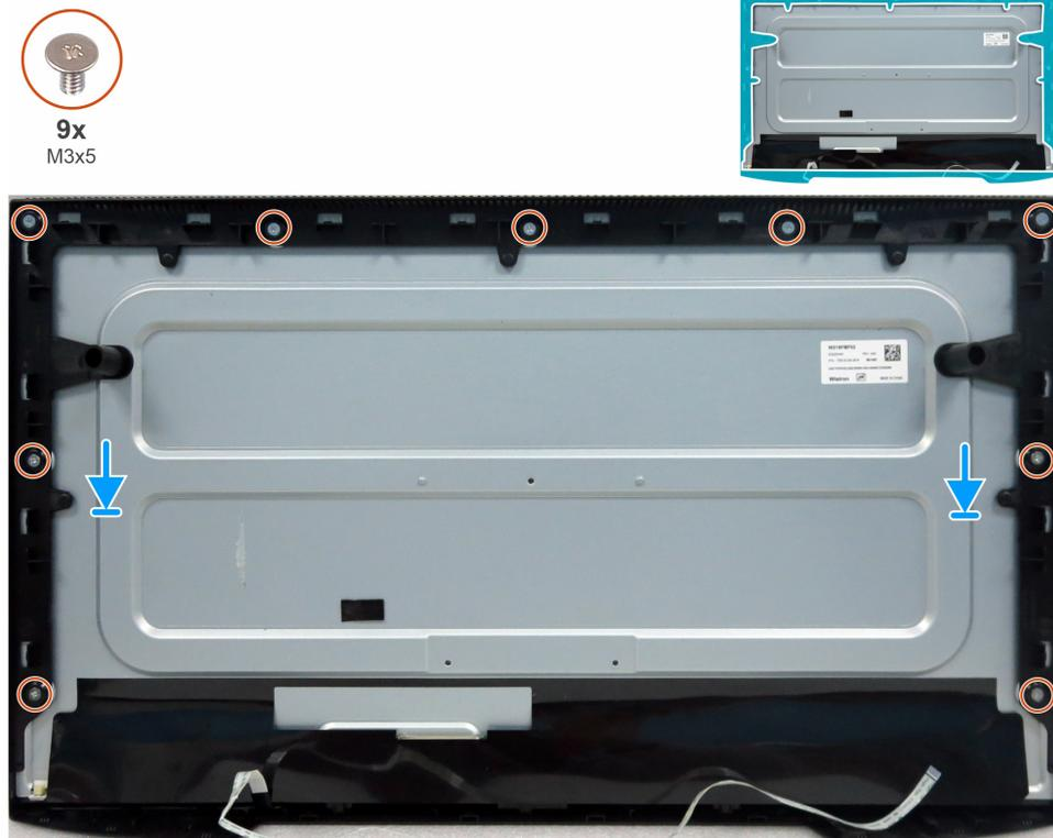
**Figura 10.** Instalación del marco central
