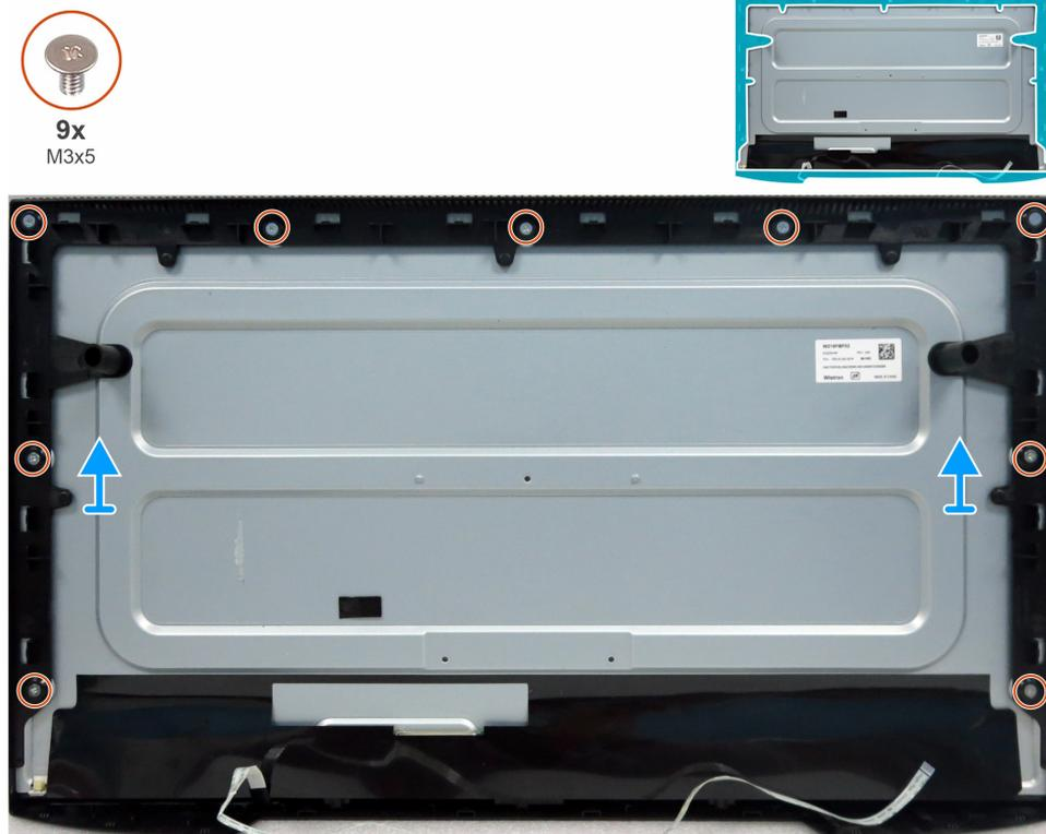
**Figura 9.** Desmontaje del marco central
