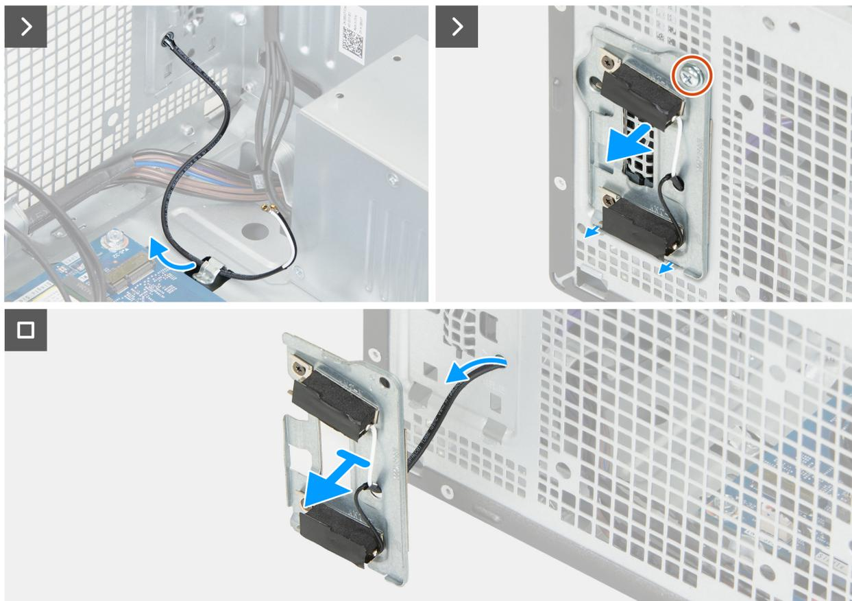
Figure 31. Retrait du module d'antenne
