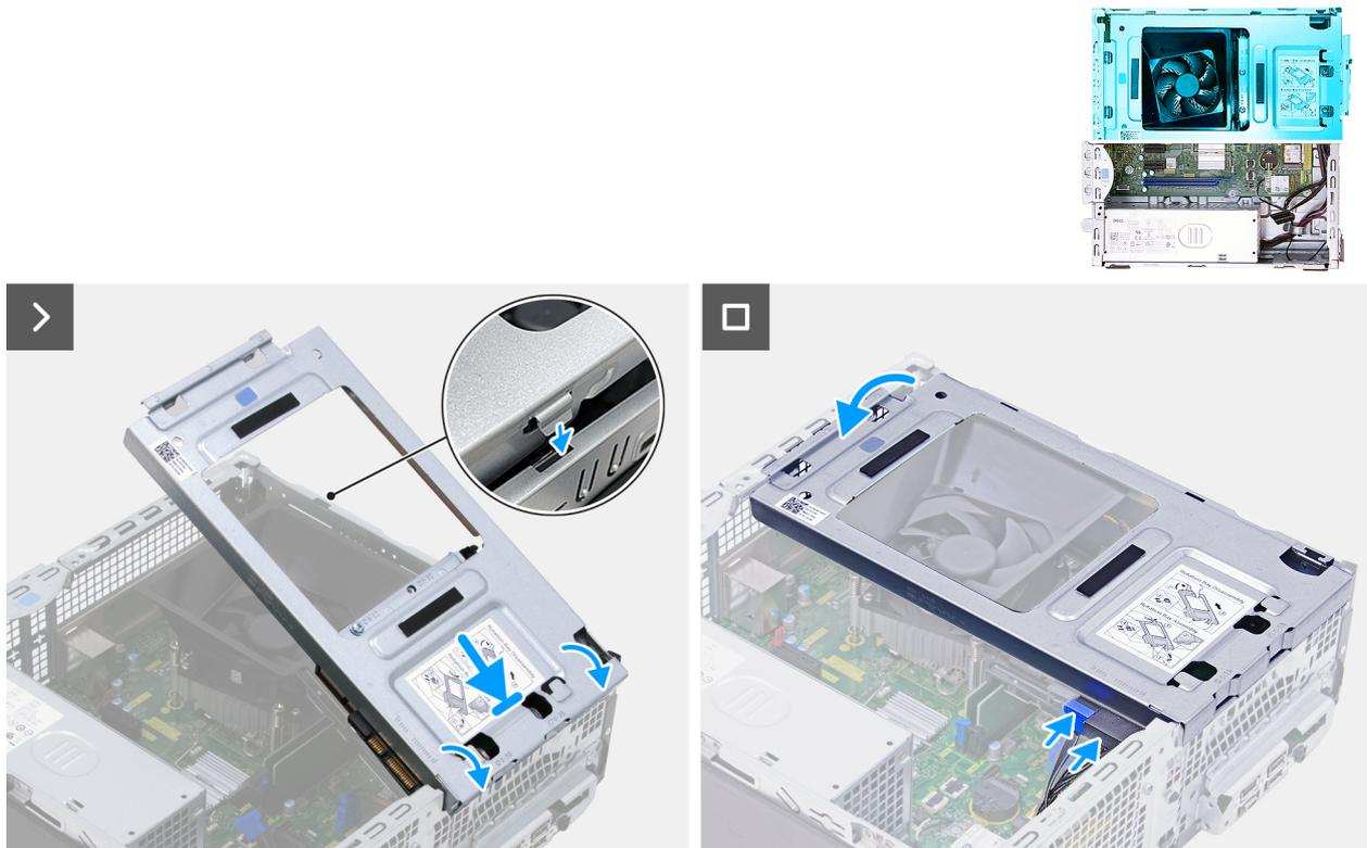
**Figure 20. Installation de la baie rotative**
