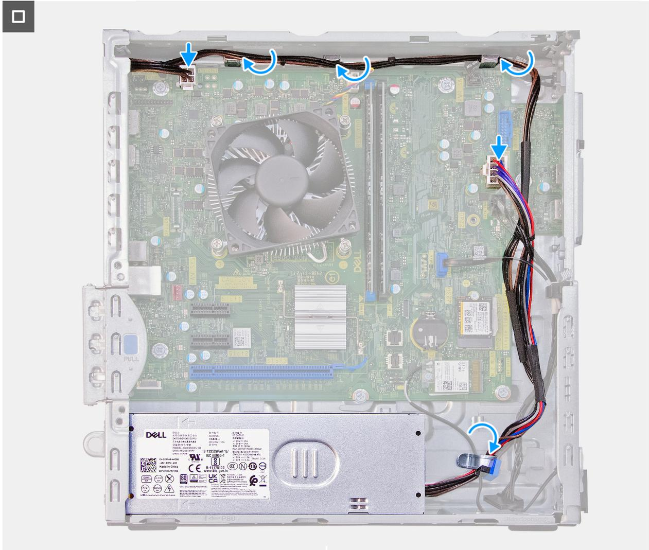
**Figure 36. Installation du bloc d'alimentation**
