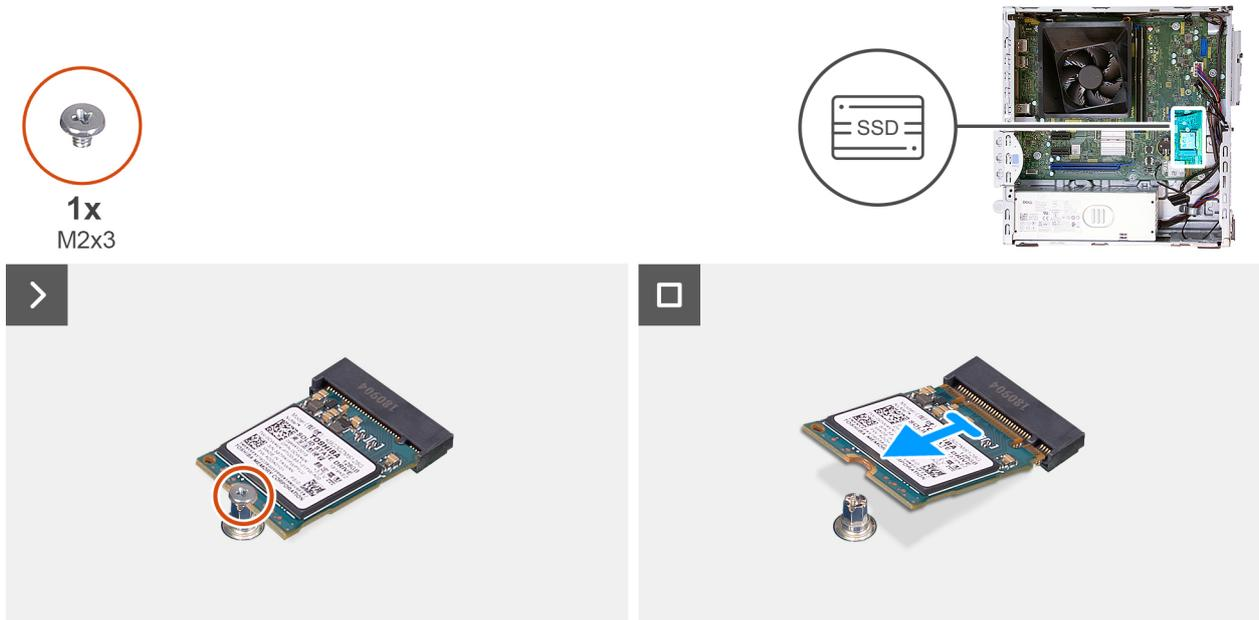
Abbildung 25. Entfernen des M.2-2230-Solid-State-Laufwerks
