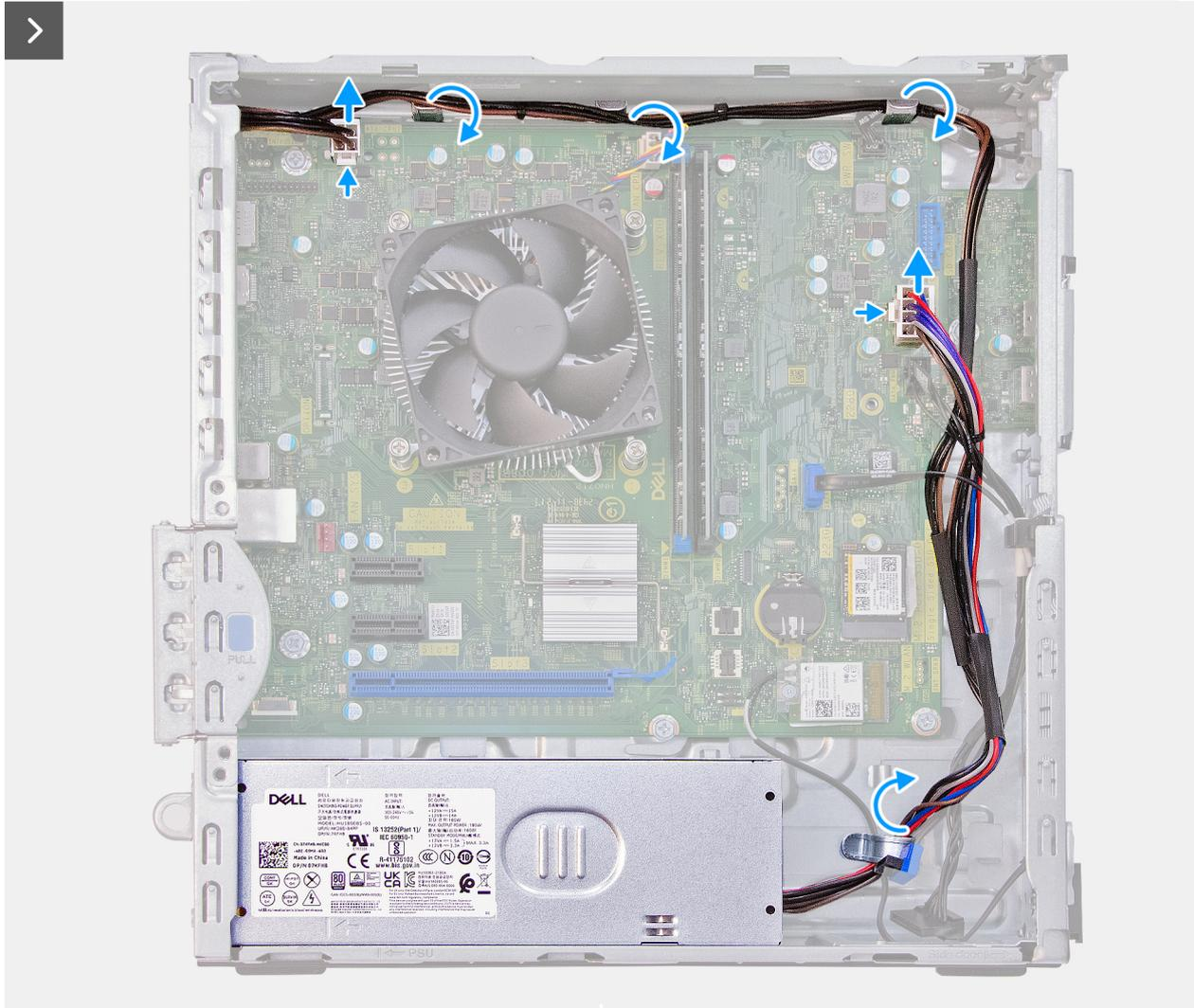
Abbildung 33. Entfernen der Stromversorgungseinheit
