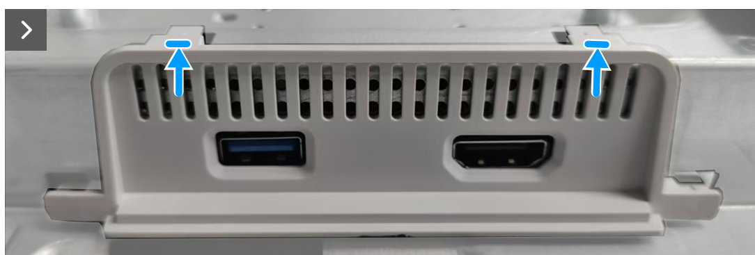
Rysunek 21. Załóż metalową osłonę pokrywy We/Wy
