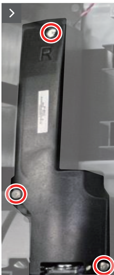
Rysunek 9. Podłącz kabel głośnika i zainstaluj śruby
