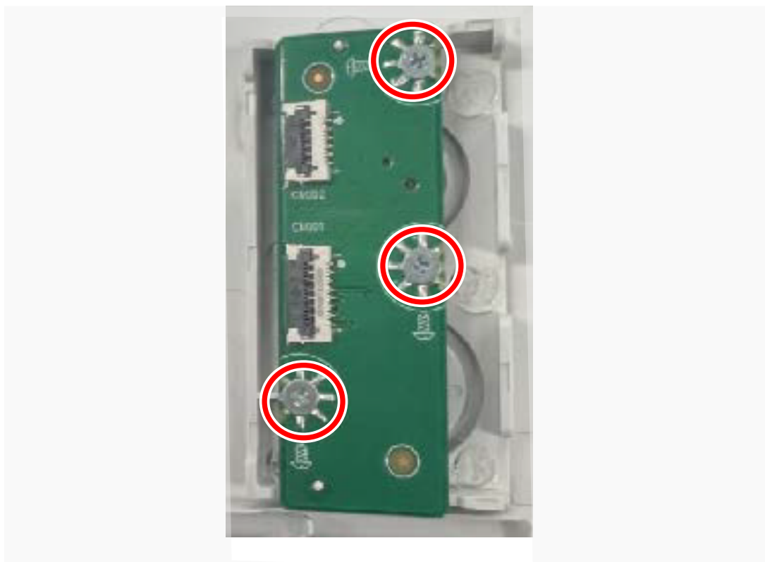
Rysunek 30. Instalacja płyty klawiatury
