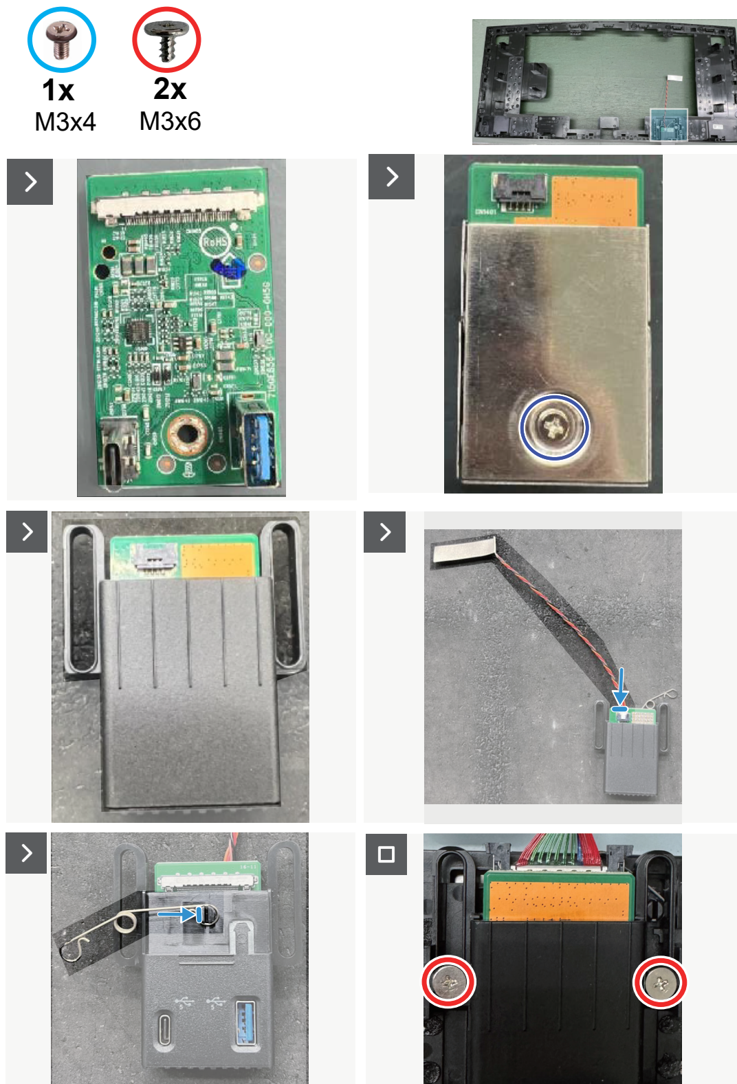
Rysunek 28. Instalacja płyty USB
