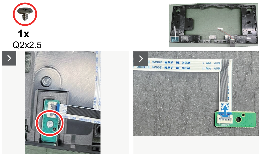
Rysunek 37. Zdejmowanie płyty obiektywu
