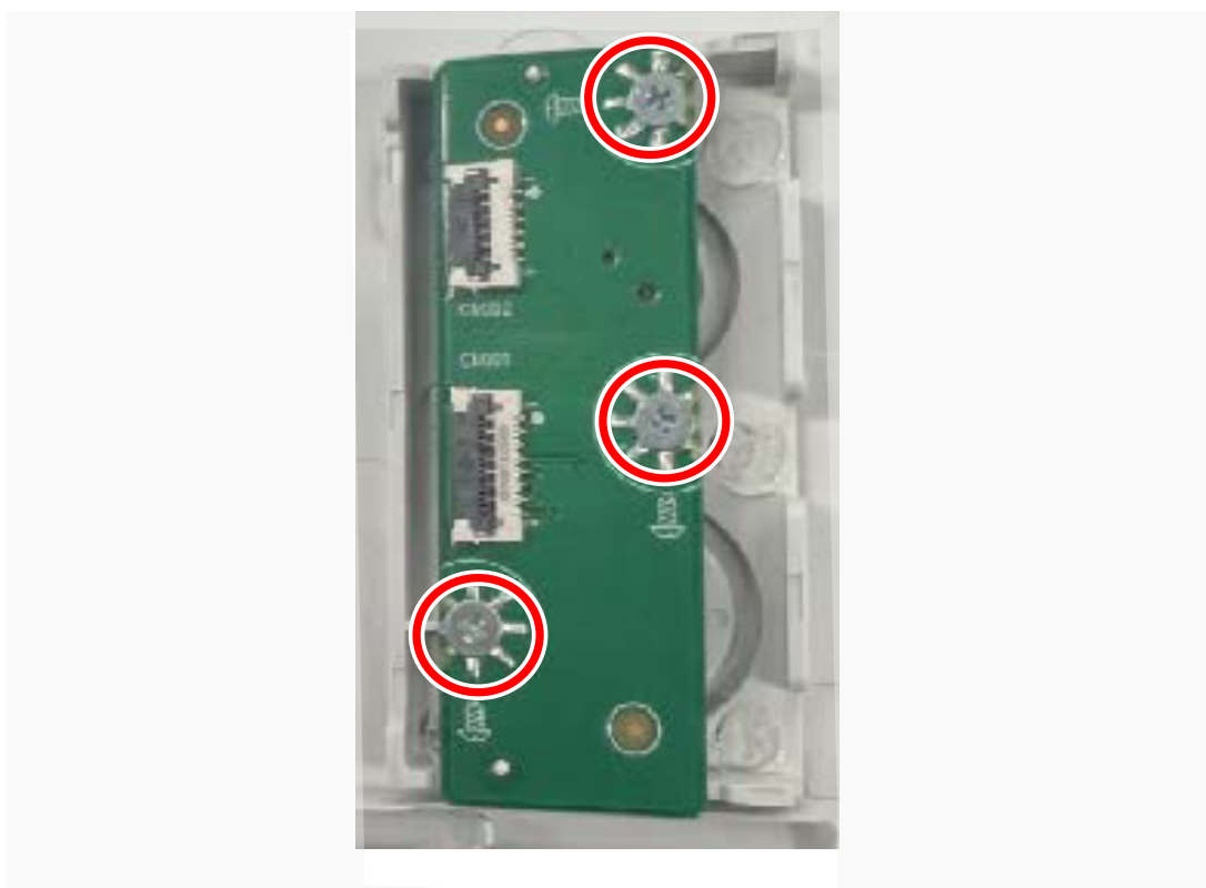
Rysunek 42. Instalacja płyty klawiatury
