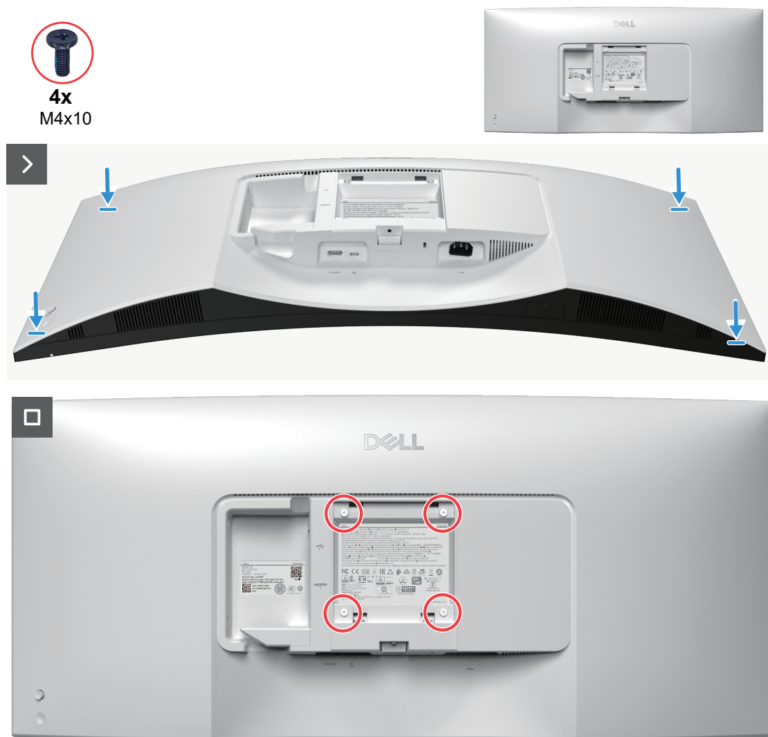
Figura 18. Voltar a colocar os parafusos
