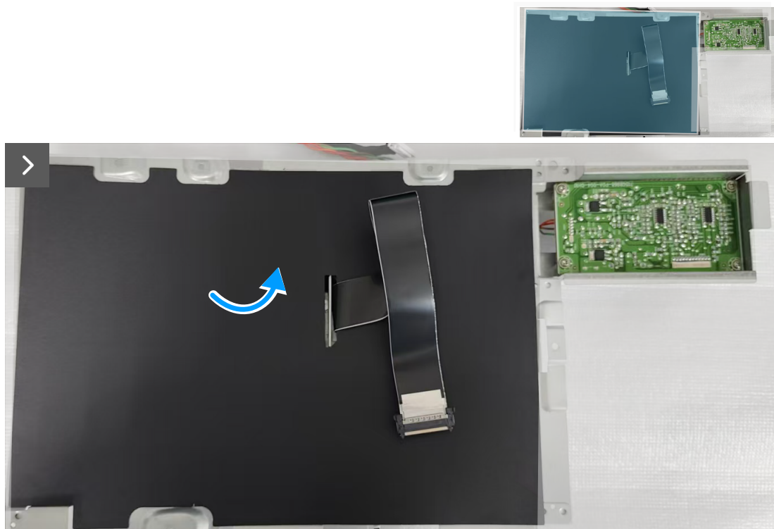
Figura 27. Remover a película Mylar
