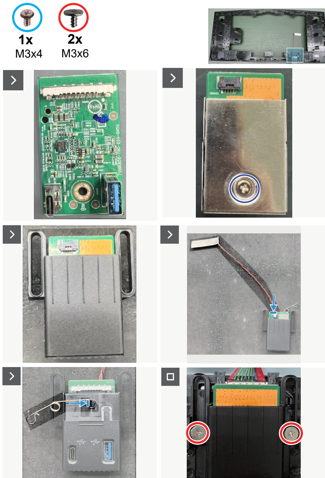
Figura 40. Instalar a placa USB
