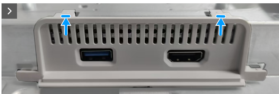
Figura 21. Riposizionamento del coperchio I/O della schermatura metallica
