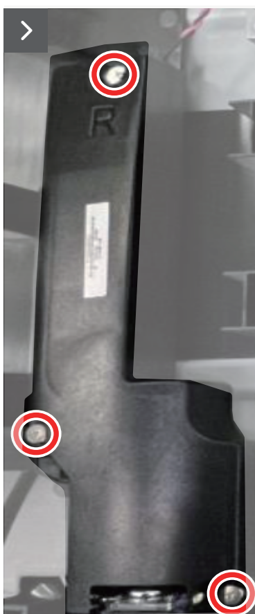
Figura 9. Conectar el cable del altavoz e instalar los tornillos
