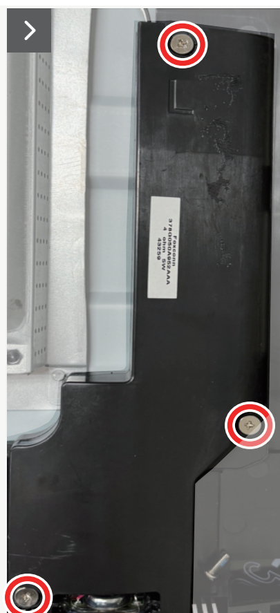
Figura 9. Conectar el cable del altavoz e instalar los tornillos
