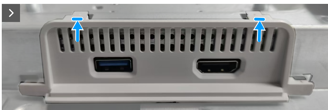
Figura 21. Volver a colocar la cubierta de E/S de la protección metálica
