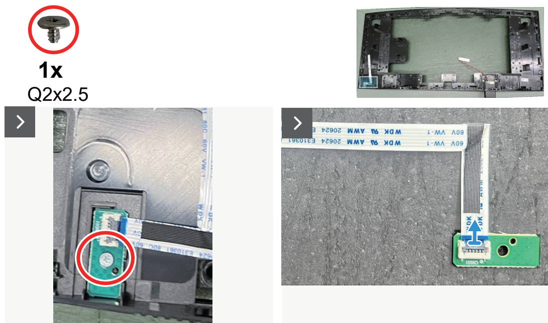
Figura 25. Retirar la placa Lens
