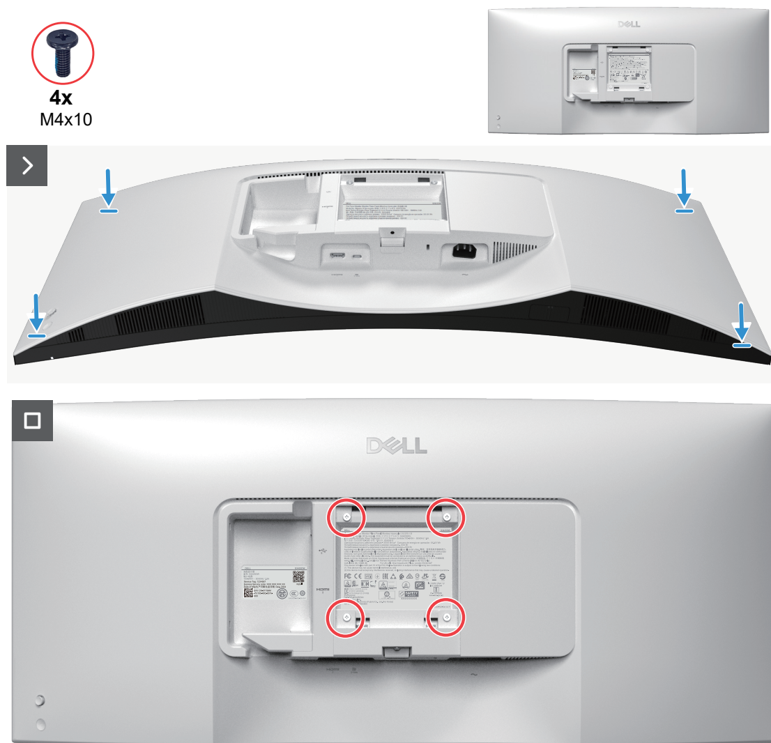
Figura 6. Volver a colocar los tornillos
