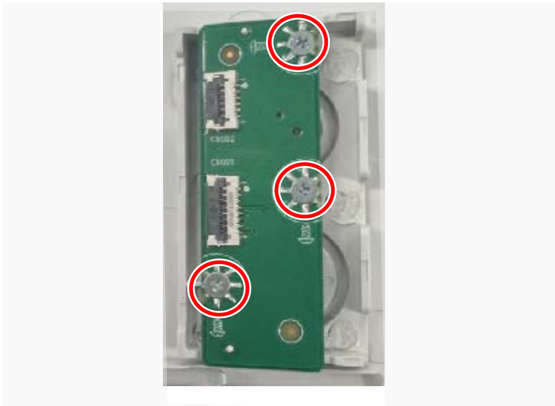
Figura 30. Instalar la placa del teclado
