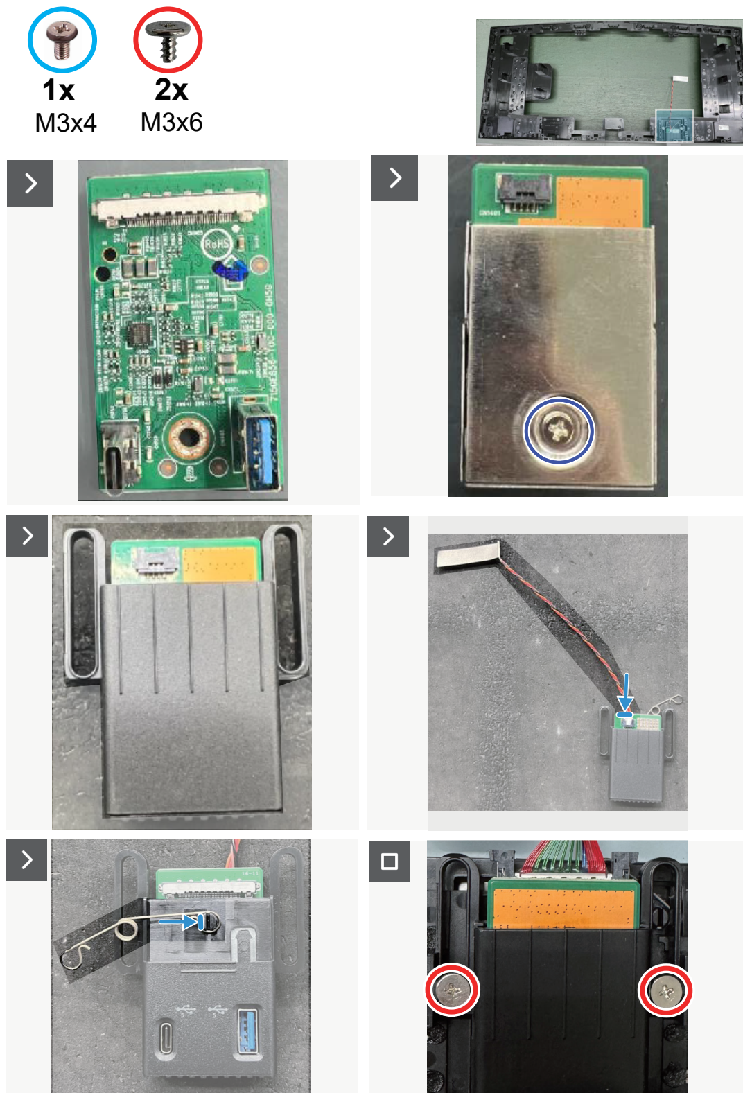
Figura 28. Instalar la placa USB
