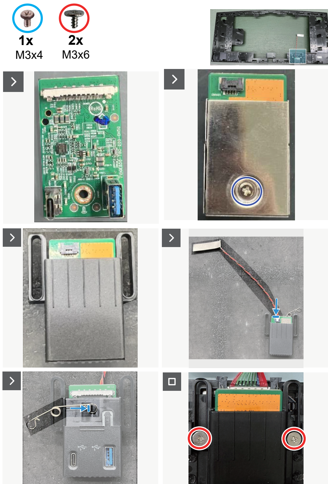
Figura 40. Instalar la placa USB
