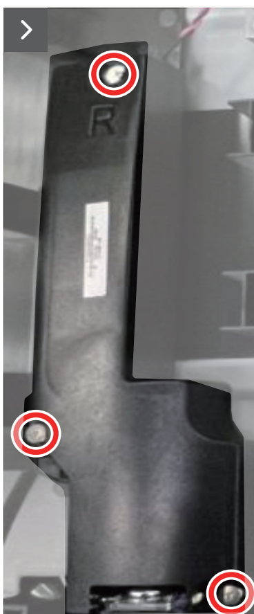
Figure 21. Brancher le câble du haut-parleur et installer les vis
