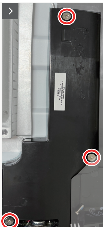
Figure 9. Brancher le câble du haut-parleur et installer les vis
